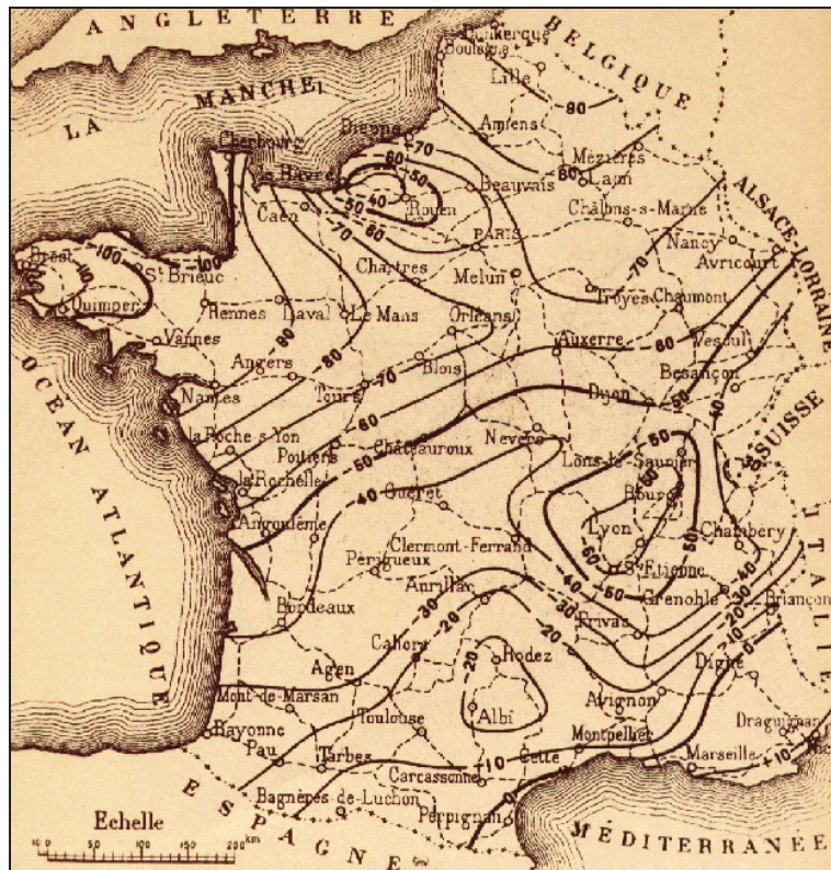
Figure IV-16 : Carte des écarts approximatifs entre les altitudes NGF-Lallemand et les altitudes NGF-Bourdalouë (source : http://geodesie.ign.fr/ , consulté le 1 er décembre 2011).
