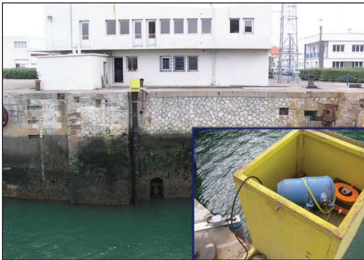
Figure IV-27 : Téli-mètre radar et puits de tranquillisation du marégraphe actuel du port de La Pallice.
