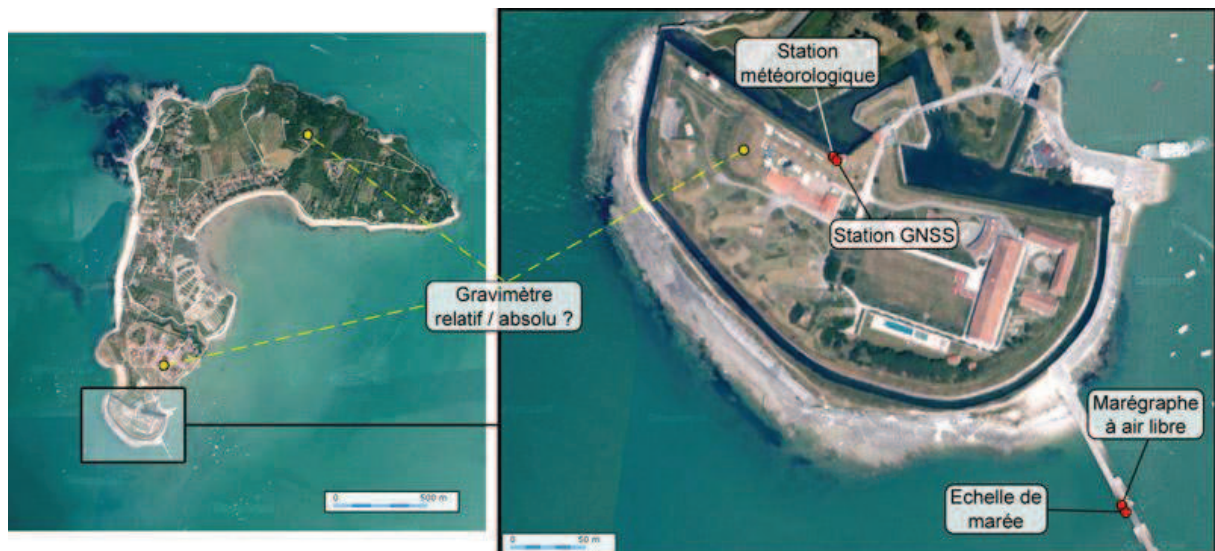
Figure IV-62 : Emplacement des différents instruments composant le nouvel observatoire scientifique de surveillance du niveau de la mer à l'île d'Aix. Les points rouges représentent des emplacements définitifs. Les points jaunes représentent des emplacements possibles. Photographies aériennes modifiées (© 2011 - IGN).
