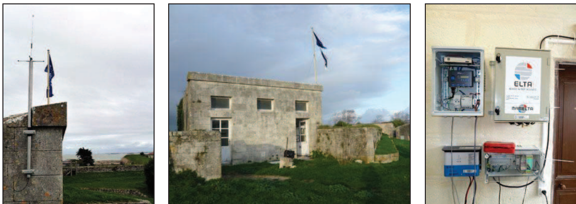
Figure IV-65 : A gauche : emplacement de l'antenne radio recevant les mesures du marégraphe. Au centre : bâtiment du fort de la rade destiné à accueillir les stations GNSS et météorologiques, en plus de l'antenne radio et des boîtiers enregistreurs. A droite : boîtiers enregistreurs des mesures du marégraphe. (2011).
