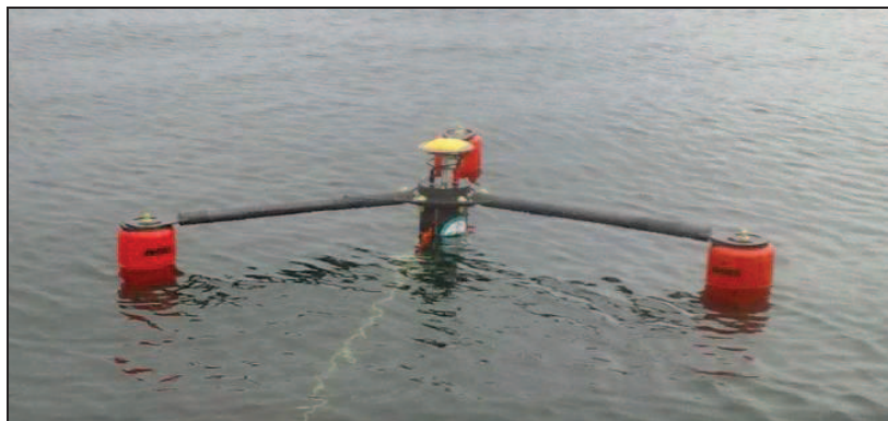
Figure I-10 : Bouée GNSS mise au point par l'Institut National des Sciences de l'Univers [Calzas et al., 2010].
