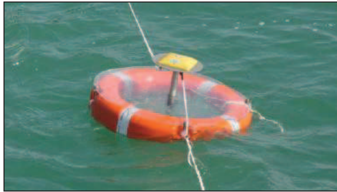
Figure I-9 : Exemple de bouée GNSS simple [Calzas et al., 2010].
