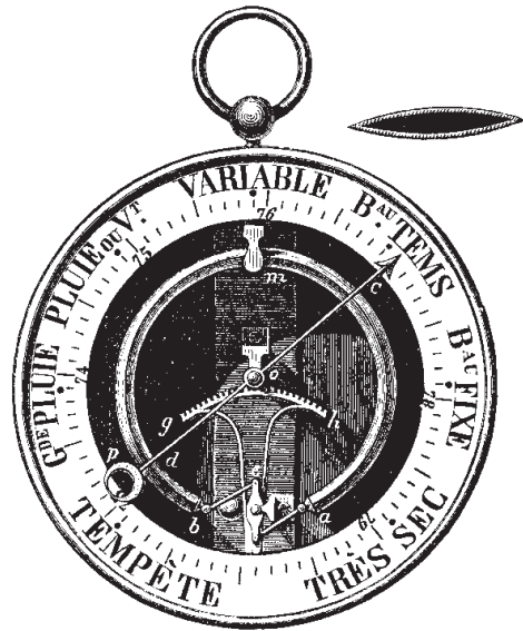
Fig. 283. — Baromètre de Bourdon.
