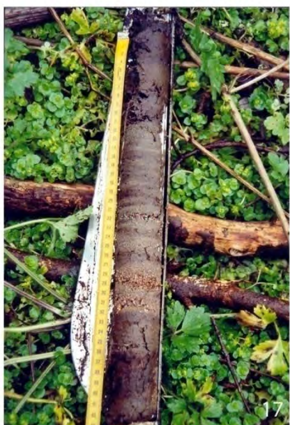
Photo 15 - Sondage à la pelle mécanique effectué sur l'estran de l'Anse Saint-Martin Photo 16 - Sondage à la tarière effectué sur le cordon de galet de l'Anse Saint-Martin Photo 17 - Carottage à la sonde russe effectué dans la vallée du Grand Douet à Biville Photo 18 - Carottage au carottier à percussion effectué dans la Réserve Naturelle Nationale de la Mare de Vauville à La Hague (Clichés L. Lespez)
