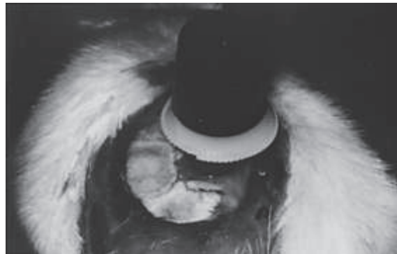
Figure 34 : Photographie montrant le système laser Doppler adapté pour mesurer le flux sanguin cortical chez le rat éveillé et non restreint. D'après Gu et coll., 1999.
