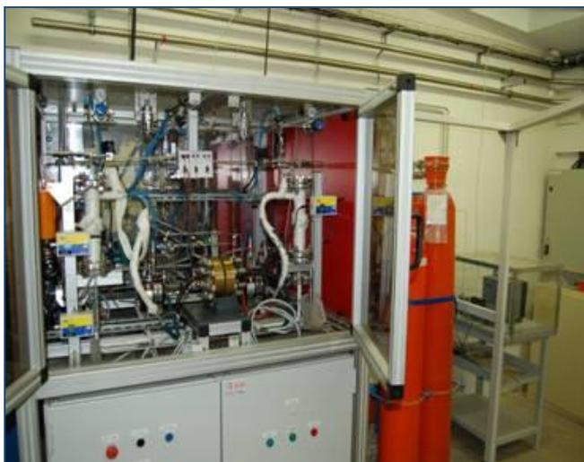
**Figure IV-10 : Banc monocellule PEM sous pression – Hélium**
