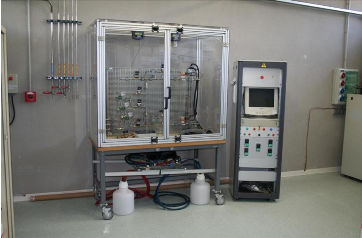
**Figure V-21 : Photos du banc PAC « petite puissance » du LAPLACE**
