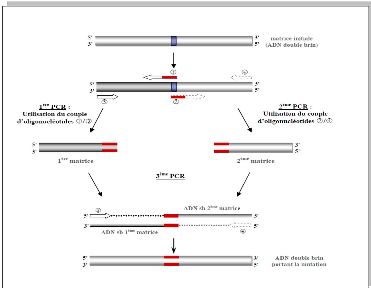
**Figure 10 :** Schéma de la PCR 3 voies
