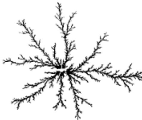
Figure 1.7 : Exemple typique de dépôt fractale de zinc formé à l'interface entre deux liquides non-miscibles d'après [34]
