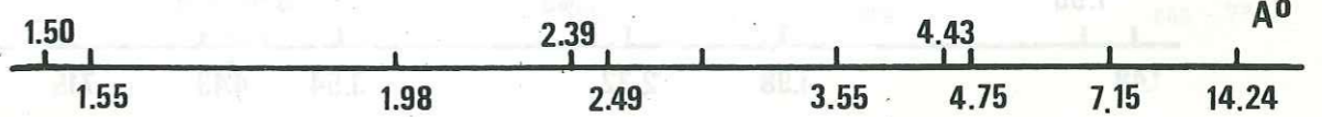
Figure II 1 : Spectres de diffraction des RX de l'assemblage argileux néoformé à moins de 15 kb et à diverses températures dans le système 2\text{SiO}_2\text{Al}_2\text{O}_3\text{MgOH}_2\text{O} . G : germe de Mgcarpholite.
