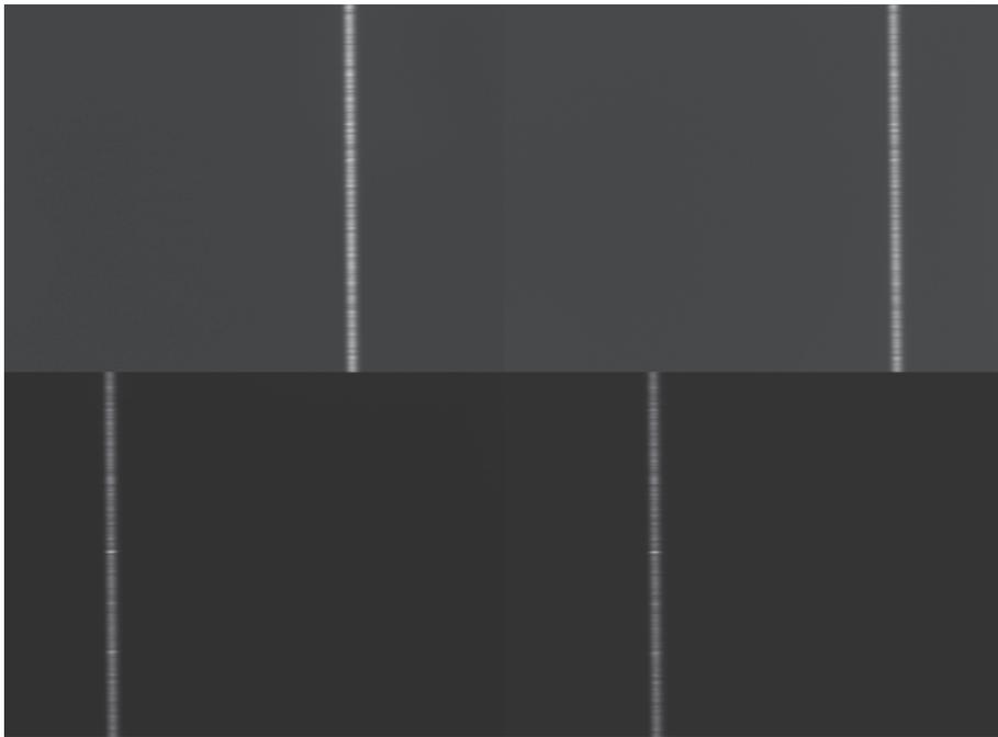
FIGURE 3.10 – Exemple de calibration. 14mm de déplacement du pointeur laser. 0,5mm d'écart entre les 2 caméras. La caméra 1 est en haut et la caméra 2 est en bas.
