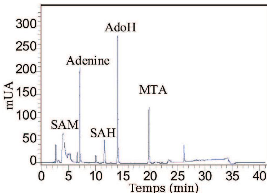
**Figure I-6-2 :** Analyse HPLC des sous-produits de la réaction catalysée par l'holo-RimO. Après 1 heure d'incubation à 50°C, les échantillons sont centrifugés (13 000 rpm, 5 min) puis injectés sur colonne C18. Les temps de rétention de chacun des composés présents dans le milieu réactionnel ont été attribués par injection de standards commerciaux.
