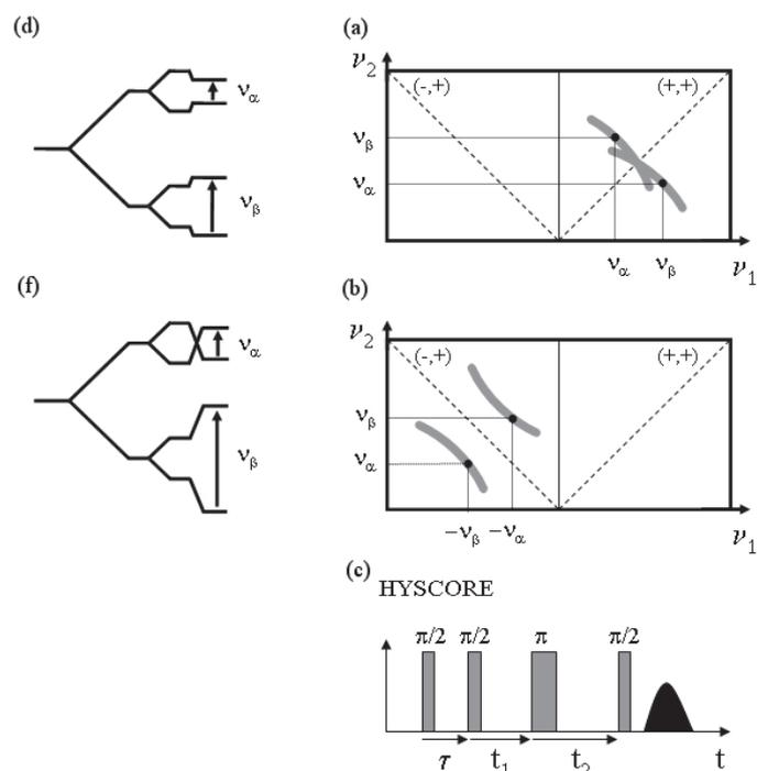
**Figure IV-2-1 : Spectroscopie HYSCORE (système  $I = \frac{1}{2}$  et  $S = \frac{1}{2}$ ).** Un couplage faible (a) est observé dans le quadrant (+,+), avec son diagramme de niveau d'énergie correspondant (d). Un couplage fort (b) est observé dans le quadrant (-,+), avec son diagramme de niveau d'énergie correspondant (f). La séquence HYSCORE utilisée est représentée schématiquement en (c) (93).
