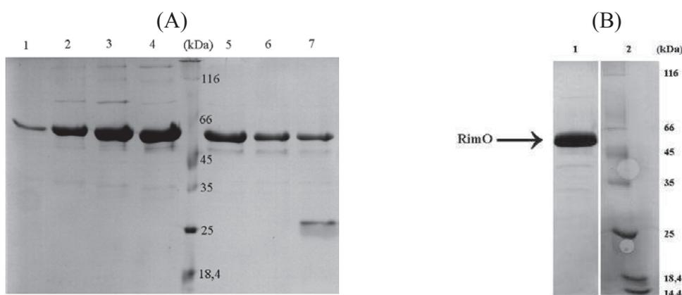
**Figure I-2-2-2 : Purification de la protéine RimO sur colonne hydrophobe Butyl-Sépharose (A) puis lavée et concentrée (B).** En (A) (1): Fractions de 20 à 24 mL ; (2): Fraction de 40 à 44 mL ; (3): Fraction de 60 à 64 mL ; (4): Fraction de 80 à 84 mL ; Marqueur de masse moléculaire ; (5) : Fraction de 100 à 104mL ; (6) : Fraction de 120 à 124 mL ; (7) : Fraction de 160 à 164mL. En (B) la protéine RimO pure à 95 %.
