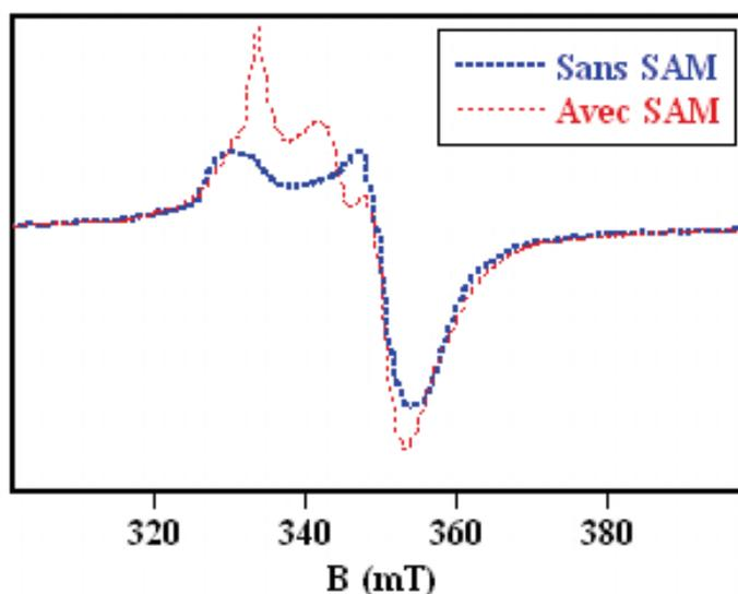
**Figure II-3-6-1 :** Spectres RPE en bande X de la protéine MiaB en absence (bleu) et en présence (rouge) de SAM. Holo-MiaB (260  $\mu$ M), 10 mM de SAM. Les spectres ont été enregistrés dans les conditions suivantes : Puissance: 10 mW, Fréquence: 9,44 GHz, Gain:  $8 \times 10^4$ , Modulation du signal: 100 kHz; Amplitude de modulation: 1 mT.
