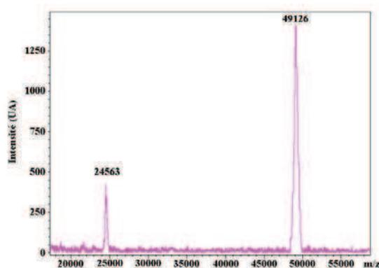
**Figure I-2-2-3-B :** Spectre MALDI-TOF de la protéine RimO pure à 95%. Deux états de protonation de la protéine RimO sont visibles ( $m/z = (M+H)/H = 49126$  et  $m/z = (M+2H)/2H = 24563$ ). Les masses théoriques sont les suivantes : ( $m/z = (M+H)/H = 49222$  et  $m/z = (M+2H)/2H = 24612$ ). La différence de masse observée est de 96 Da, compatible avec la précision affichée de l'appareillage utilisé ( $\pm 100$  Da).
