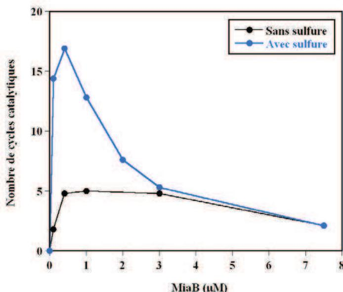
**Figure II-1-2-3 :** Activité de l'holo-MiaB en absence et en présence de sulfure. L'holo-MiaB ( $0,2\text{-}7,5 \mu\text{M}$ ) est incubée en anaérobiose 60 min à  $65^\circ\text{C}$  dans un volume final de  $100 \mu\text{L}$  en absence (noir) ou en présence (bleu) de  $500 \mu\text{M}$  de sulfure de sodium,  $2,5 \text{ mM}$  de dithionite et  $50 \mu\text{M}$  d' $\text{ARNt}^{\text{Phe}}$  ( $65\text{-}85\%$  pure).
