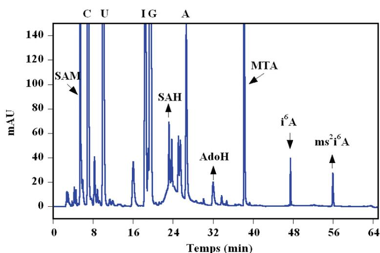
**Figure II-1-2-2 :** Chromatogramme type du milieu réactionnel après réaction. La SAM et  $i^6A$  sont consommés (flèche descendante) tandis que la SAH, AdoH et  $ms^2i^6A$  sont produits au cours de la réaction (flèche ascendante). Selon le temps de la réaction à 65°C et de la digestion des ARNt à 37°C, la quantité d'adénine varie et sort sous la forme d'un pic très large (22-26 min).
