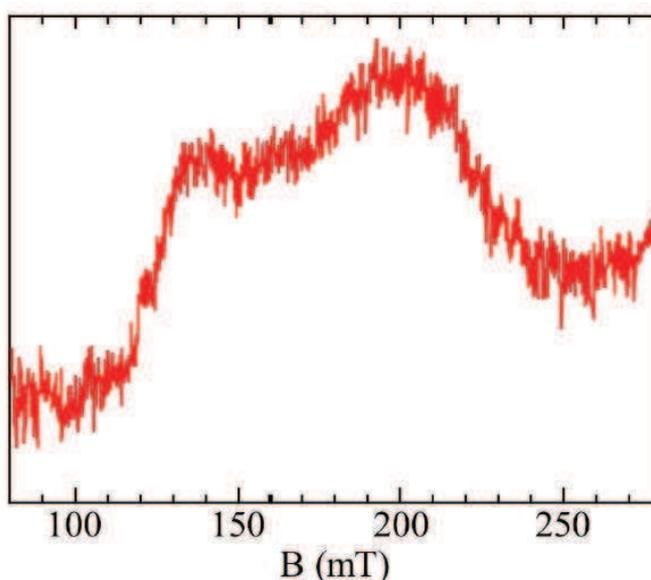
**Figure I-5-2-3 :** Spectre RPE en bande X à bas champ de l'holo-RimO. Les centres  $[4\text{Fe-4S}]^+$  de l'holo-RimO (144  $\mu\text{M}$ ) ont été reconstitués *in vitro* en présence de  $^{57}\text{Fe}$  puis réduit par 8 excès de dithionite ( $V_f = 200 \mu\text{L}$ ). Le spectre a été enregistré dans des conditions non saturantes à 4.3 K avec  $P = 50 \text{ mW}$  et  $F = 9.65 \text{ GHz}$ .
