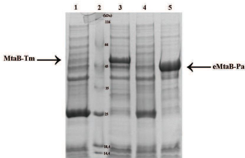
**Figure III-5-4** : Profil de surexpression des MTTases MtaB de *T. maritima* (TM0830) et eMtaB de *P. abyssi* (PAB1134) sur gel SDS-PAGE 12%. Contrôle de la souche *E. coli* BL21(DE3) RIL<sup>®</sup> (1) et (4) où seule la chloramphénicol acétyltransférase est produite abondamment. Induction par IPTG de la protéine MtaB de *T. maritima* (49 324 Da) (3). Induction par IPTG de la protéine Cdkal1 de *P. abyssi* (48 537 Da) (5).
