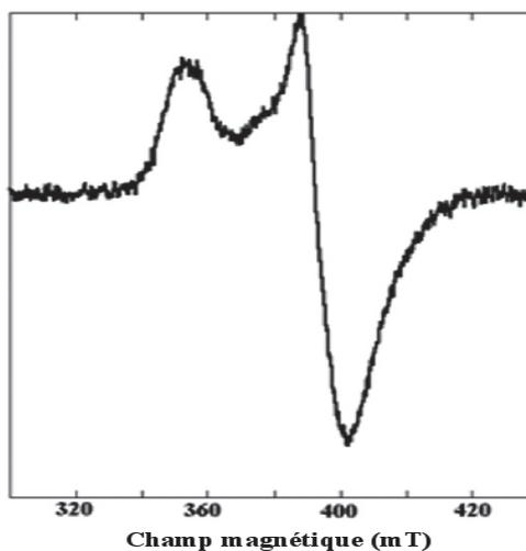
**Figure III-5-3-B** : Spectre RPE en bande X de l'holo-MtaB de *B. subtilis*. La protéine holo-MtaB (100  $\mu$ M) est réduite par le dithionite (1 mM) dans du tampon Tris-Cl 50 mM, KCl 50mM, pH 8,0. Conditions d'enregistrement : P = 100  $\mu$ W; f = 9.6 GHz; Mod = 1 mT; T = 12K.
