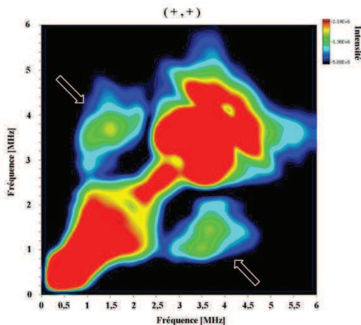
**Figure II-3-1 :** Spectre HYSCORE de la protéine MiaB-3M dans le quadrant (+,+). L'holo-MiaB-3M (607  $\mu$ M) est réduite avec 18 excès de dithionite. Les flèches pointent les deux taches de corrélation montrant la présence d'un atome d'azote proche du cluster.
