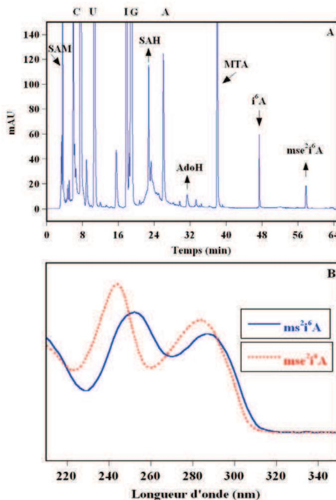
**Figure II-1-2-4 :** Chromatogramme du milieu réactionnel sur colonne C18 par HPLC (A) et spectre UV-vis de ms<sup>2,6</sup>i<sup>6</sup>A (noir) et mse<sup>2,6</sup>i<sup>6</sup>A (rouge) (B). L' holo-MiaB (1  $\mu$ M), est incubée en anaérobiose 60 min à 65°C en présence de sélénure (500  $\mu$ M), de dithionite de sodium (2,5 mM) et d'ARNt<sup>Phe</sup> (40  $\mu$ M).
