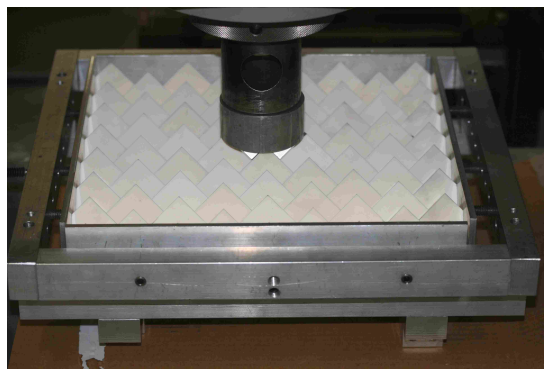
FIGURE 2.7 – Photo de l'assemblage à l'intérieur de la machine de traction
