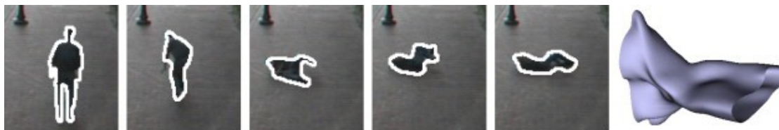
FIGURE 2.8 – Représentation du volume spatio-temporel par stéréo-association des points du contour de la silhouette extraite à chaque image, afin de créer une surface 3D. (©Yilmaz et Shah [158])
