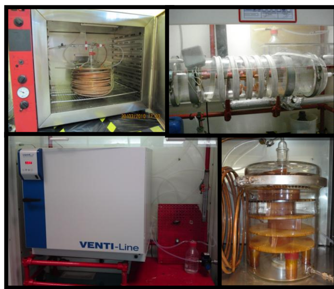
Figure 3.10. Installation pilote utilisée pour l'élaboration des produits composites par la technique SCVD-AP.
