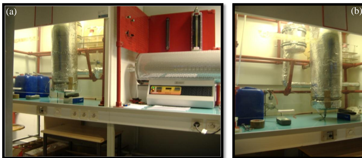
Figure 3.8. Installation pilote utilisée pour l'élaboration des produits nanocomposites par le procédé CVD-ML : vue générale (a), unité de synthèse (b).
