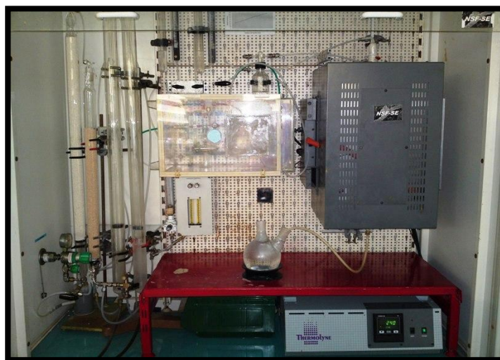
Figure 3.7. Vue générale de l'installation utilisée pour l'élaboration des produits composites par le procédé CVD-ML.
