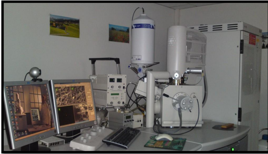
Figure 3.15. Microscopie électronique à balayage Quanta 200 Feg.
