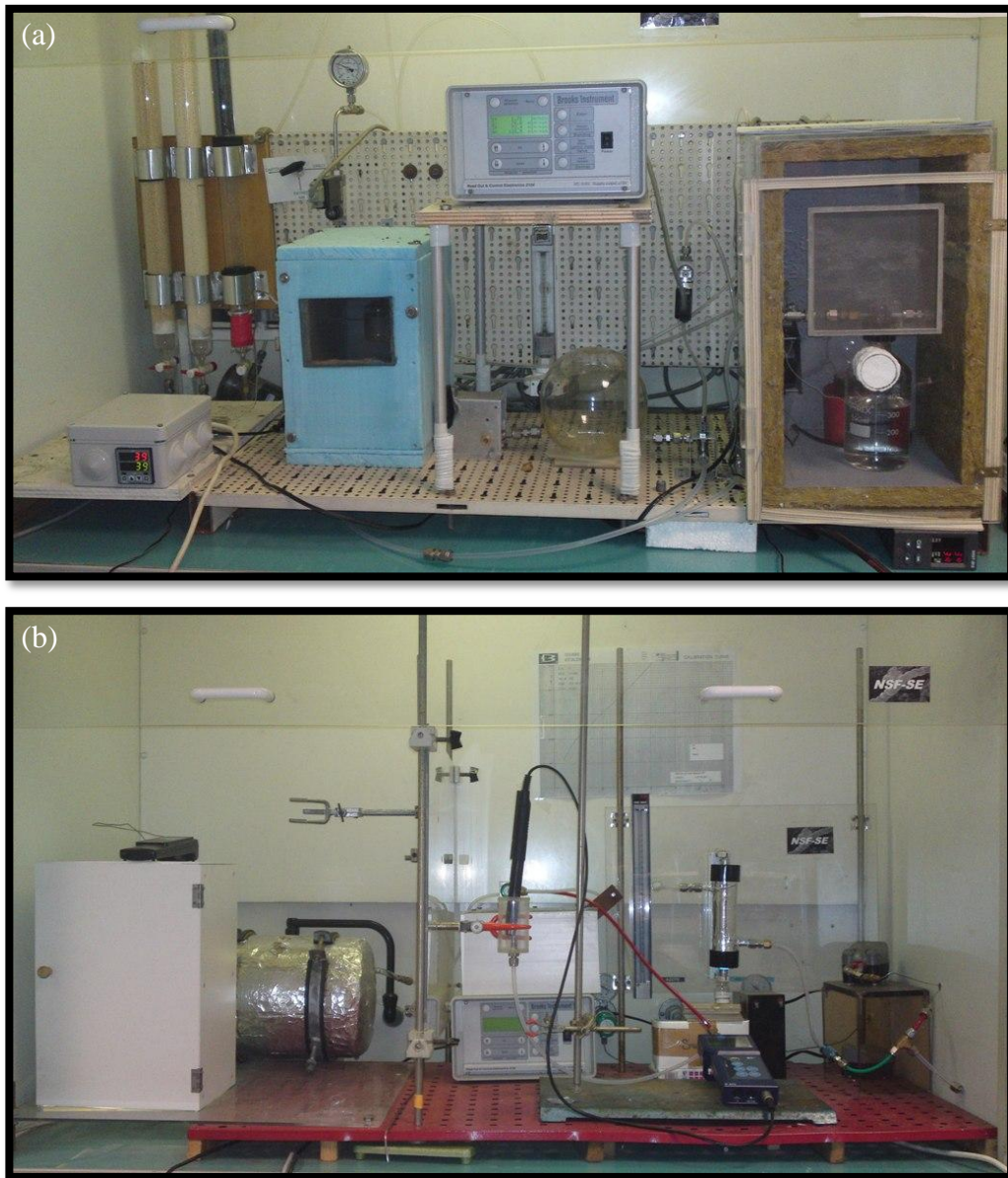
Figure 3.23. Vue générale de l'installation de test : (a) banc de dilution, (b) réacteur photocatalytique tubulaire.
