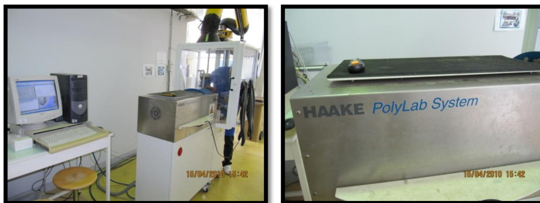
Figure 3.4. Four de fusion avec commande par ordinateur (HAAKE ProLab System).
