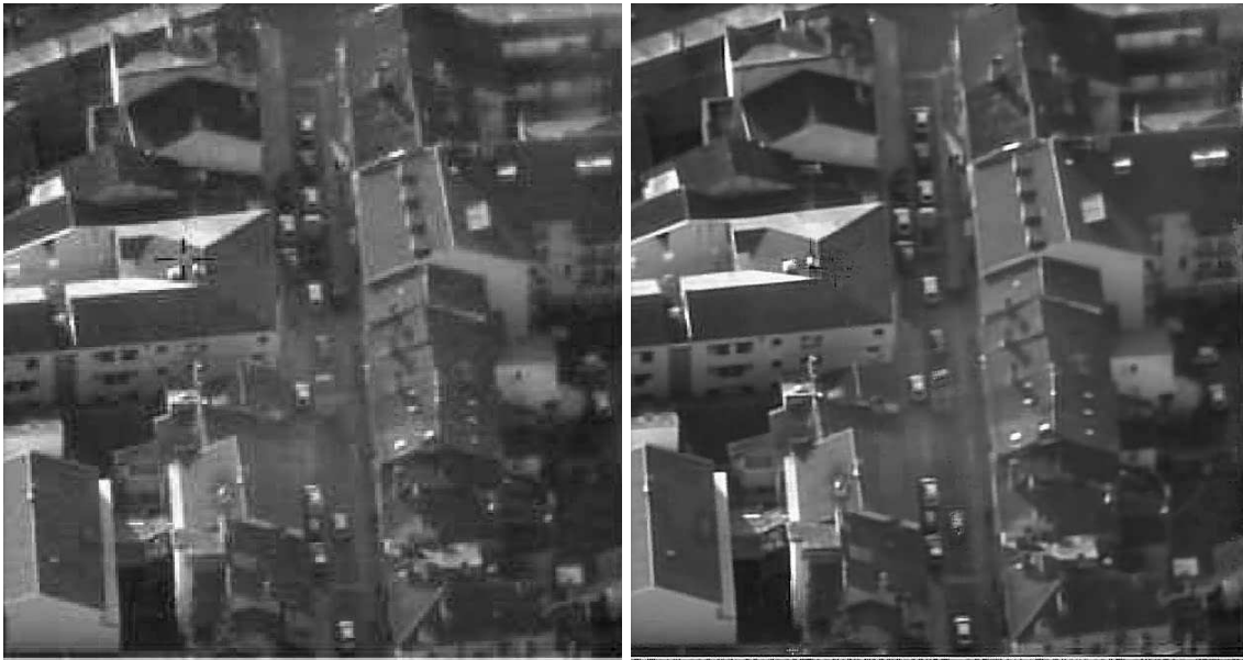
Figure 4.40 – SR en facteur 6 avec 17 images de la séquence Aerien2 affectée d'un fort bruit de compression. A gauche, image BR d'origine zoomée ; à droite, résultat SR. Les paramètres de traitement sont donnés en Table B.3.
