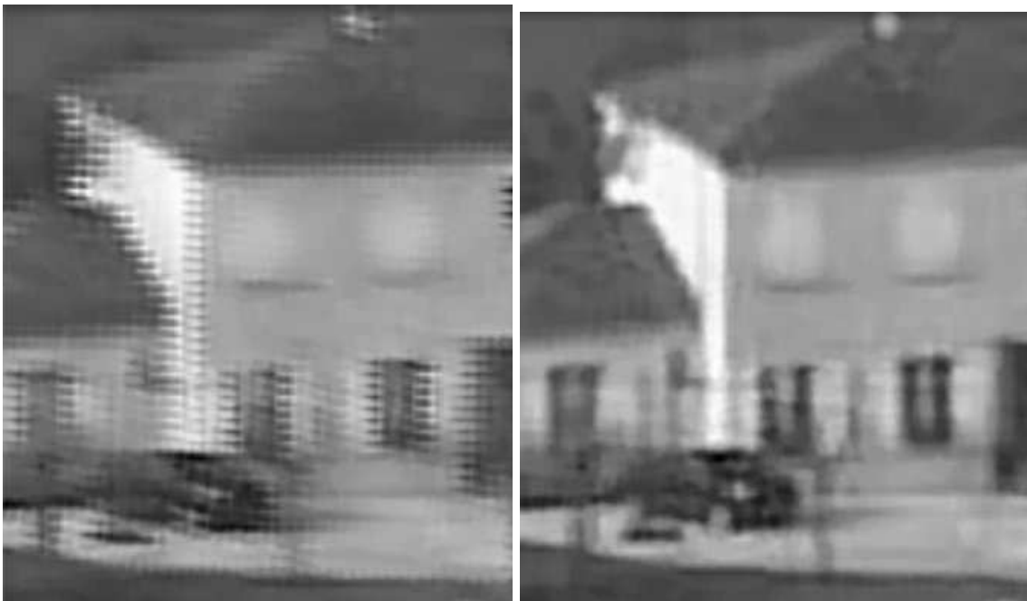
Figure 4.46 – Comparaison de techniques de recalage pour la SR sur la séquence Aerien1. A gauche, recalage sous hypothèse de mouvement global de translation 2D ; à droite, recalage par flot optique FOLKI. Les paramètres de traitement sont donnés en Table B.3.
