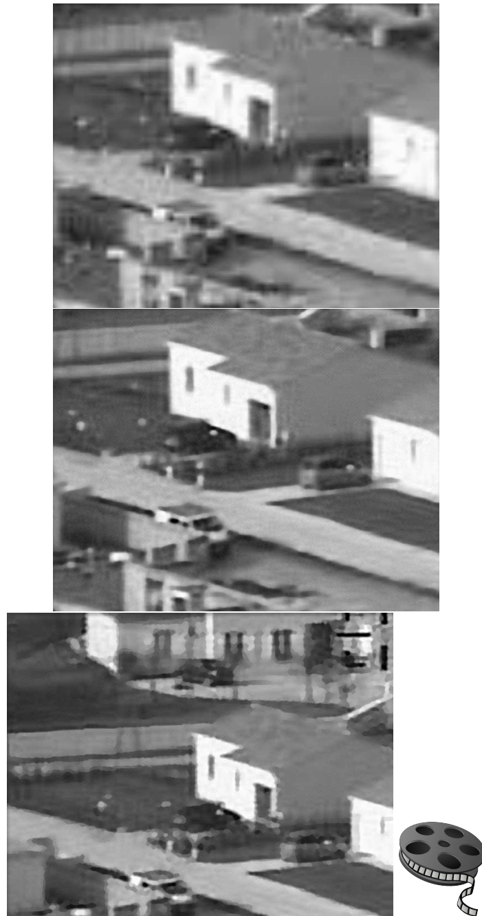
Figure 4.42 – Detail d'images SR sur la séquence Aerien1 : en haut, image BR mise à l'échelle, au milieu pénalisation non-quadratique (Huber), en bas pénalisation non quadratique avec fort effet cartoon (Geman). Les paramètres de traitement sont donnés en Table B.3.
