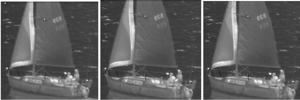
Figure 4.16 – SR sur la séquence Voilier. De gauche à droite : SR quadratique itérative, SR itérative non quadratique avec une pénalisation robuste par fonction de Huber effet cartoon modéré, effet cartoon fort. Les paramètres sont en table B.3.
