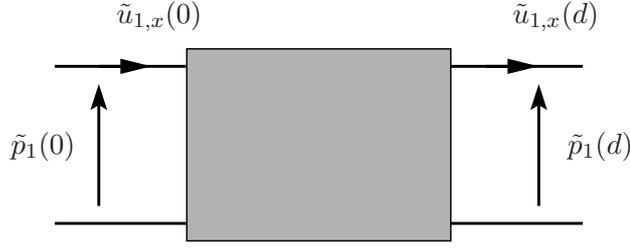
**FIGURE A.1** – Convention pression-débit utilisée pour la description des quadripôles. Orientation anti-symétrique.
