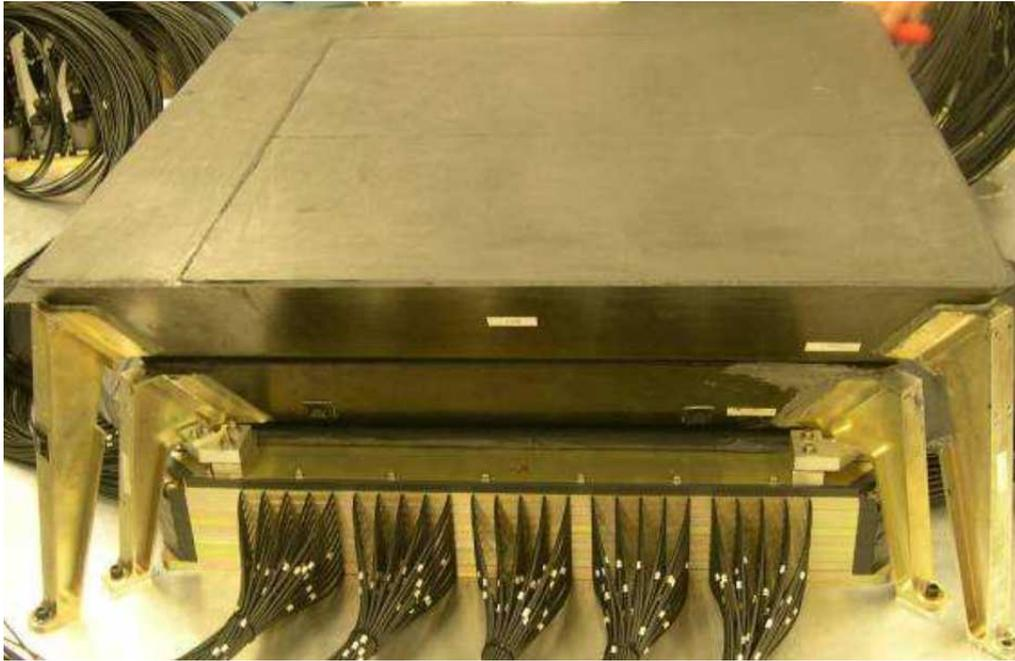
FIGURE 5.8 – Photographie des cibles de carbone (les deux trapézoïdes noirs sur le dessus) et du calorimètre. En dessous, on peut voir les couches de tungstène ainsi que les fibres optiques qui transportent les photons jusqu’aux photodiodes.
