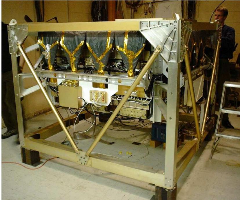
FIGURE 5.3 – Photo du TCD et de sa structure de support. On peut voir les 4 raquettes noires du plan inférieur qui collectent la lumière.
