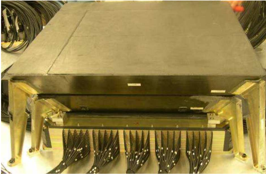
FIGURE 5.8 – Photographie des cibles de carbone (les deux trapézoïdes noirs sur le dessus) et du calorimètre. En dessous, on peut voir les couches de tungstène ainsi que les fibres optiques qui transportent les photons jusqu’aux photodiodes.
