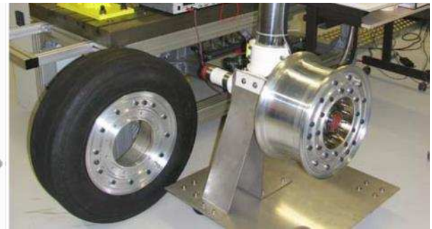
d) Roue avant électrique de « green taxi » en cours de développement.
