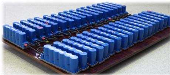
Figure V.32 : Photo des 35 modules en série pour un essai à 400Vdc.
