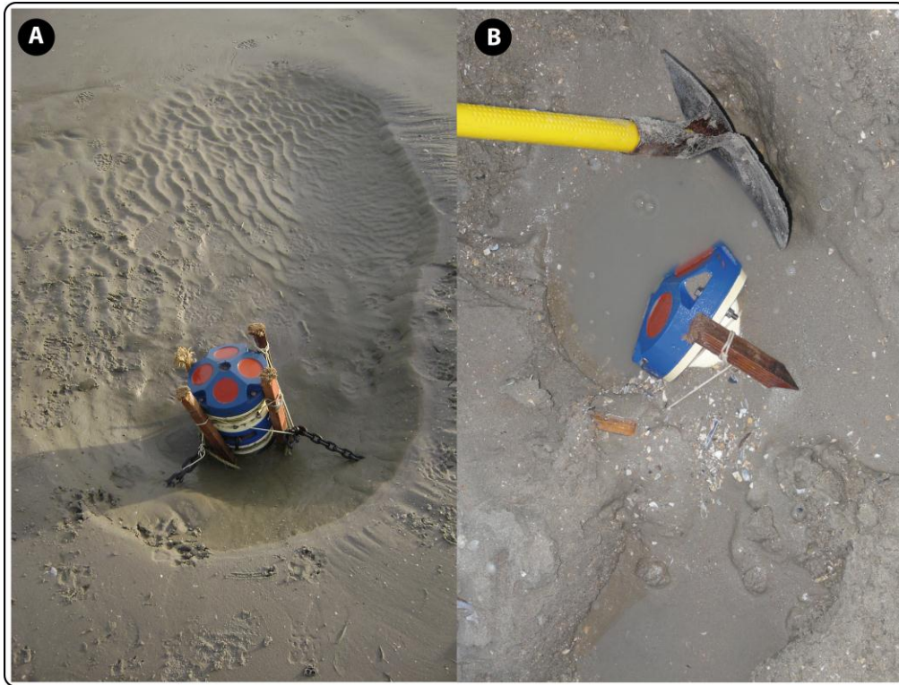
Photo II-1 : A) Affouillement autour d'un ADCP, HA10. B) Ensablement d'un ADCP, ZY09.
