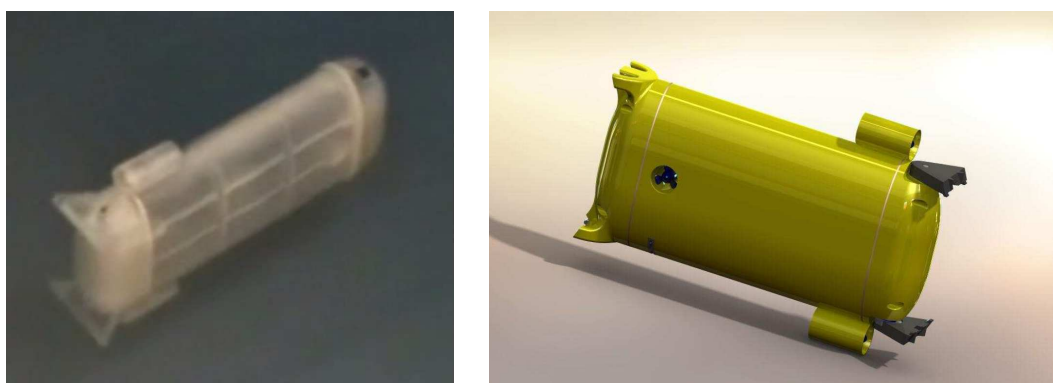
FIGURE 5.1 – Photographie du module ANGELS (gauche) et une vue CAO isométrique (droite).
