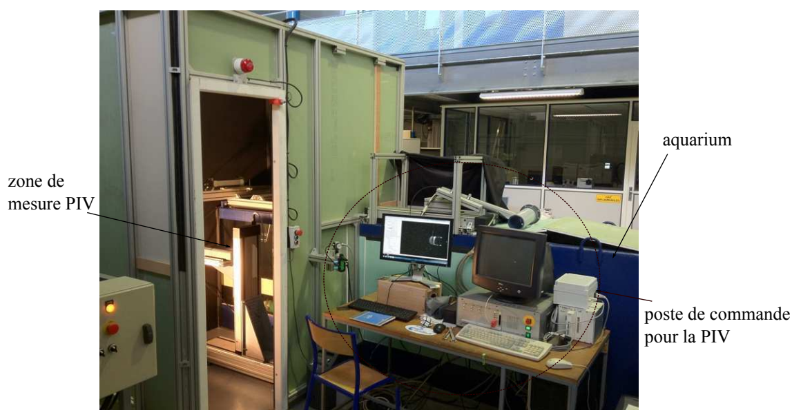
FIGURE 1.8 – Photographie du banc d'essai instrumenté pour effectuer des mesures PIV.
