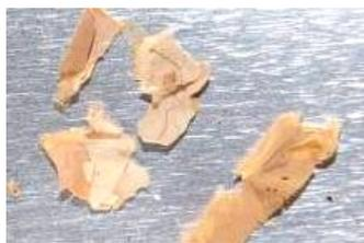
Figure 31 : Photographie du film hybride Tannin-20 après calcination de l'oligoester (52 h à 300°C)
