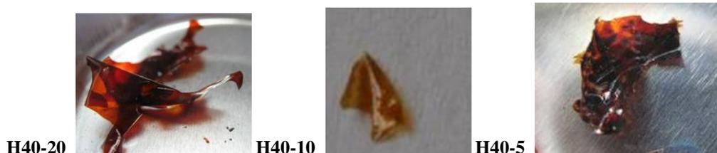
Figure 21 : Films hybrides à base de polyester hyperramifié H40 après calcination (52 h à 300°C) et influence de la teneur en composés inorganiques (20, 10, 5% massique équivalent SiO<sub>2</sub>)
