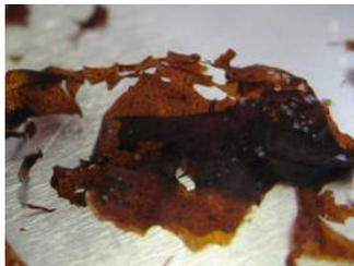
Figure 36 : Film hybride H40-10 nanochargés après calcination du polyester (52 h à 300°C)
