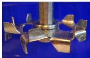
Figure 2 : Turbine défloculeuse
