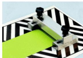
Figure 1 : Applicateur de film Bird – Elcometer
