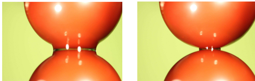
FIGURE 3.25 – Photos de pont liquide pour une succion de 10 Pa durant une phase de séchage (photographie de gauche) et de mouillage (photographie de droite).
