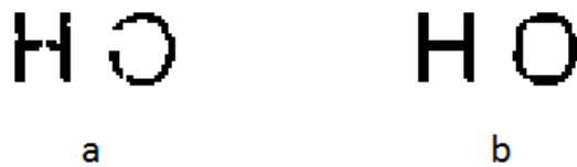
FIGURE 2.5 – Fermeture morphologique appliquée à des caractères dégradés. Ceci permet de fusionner deux composantes connexes qui faisaient parties du même caractère originellement.
