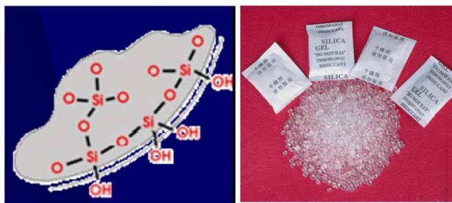
FIGURE 1.2.3: Gels de silice schématisés, en vrac et en conditionnés sachet [Palomo, 2009]
