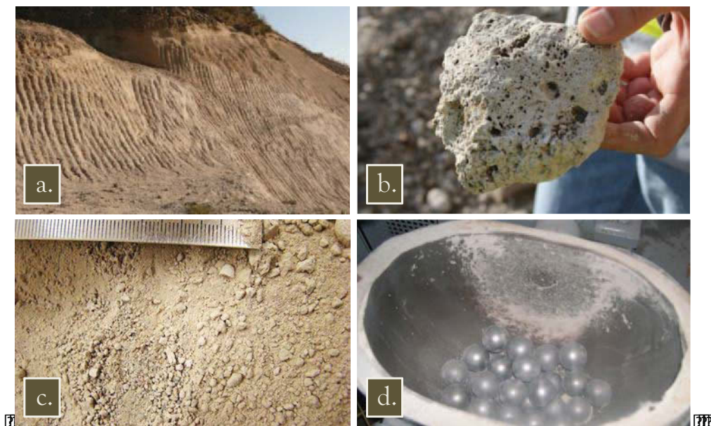
Figure II. 17. Photos de la ponce trachytique et du dispositif de transformation. Carrière du cheix (a), gros élément de ponce trachytique présent dans le sable (b), sable de ponce brut (c) et broyeur à boulet (d).
