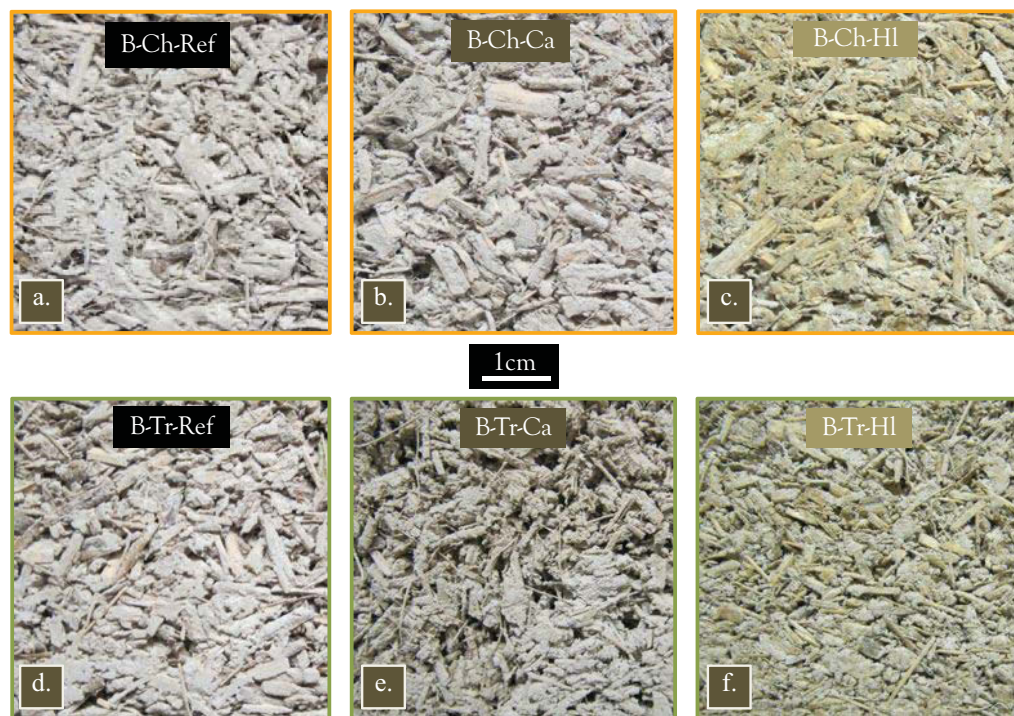
Figure III. 41. Photographies de la surface des bétons de chanvre (B-Ch-Ref (a), B-Ch-Ca (b), B-Ch-HI (c)) et de tournesol (B-Tr-Ref (d), B-Tr-Ca (e), B-Tr-HI (f)).
