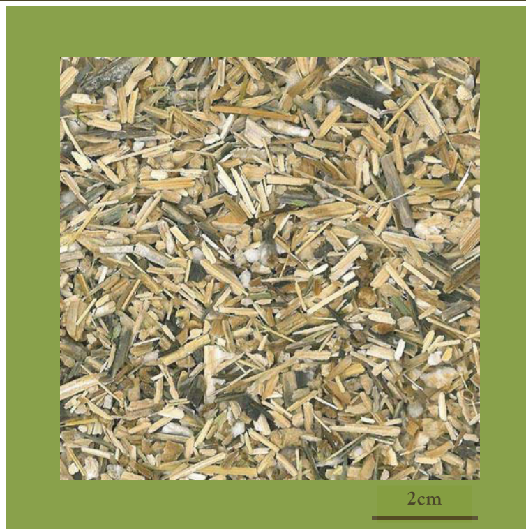
Figure II. 22. Granulat de tige de tournesol broyée brut, taille réelle.
