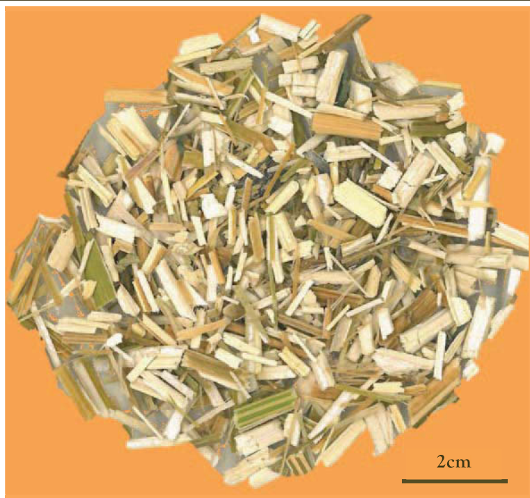
Figure II. 21. Granulat chanvre d'Auvergne brut, taille réelle
