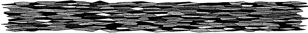
FIG. 4.29 – La structure de 311 grains déformé avec \varepsilon_\infty = 1 en absence de la loi d'écrouissage.
