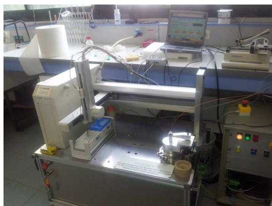
Figure II.44. Test du capteur pH-ChemFET dans le masticateur électronique
