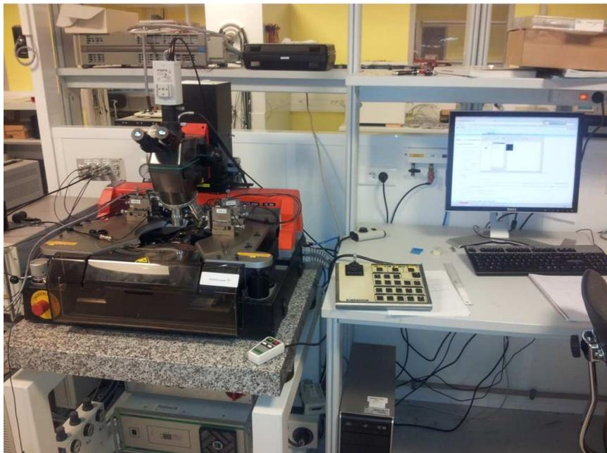
Figure II.25. Testeur sous pointe Karl süss PA 200
