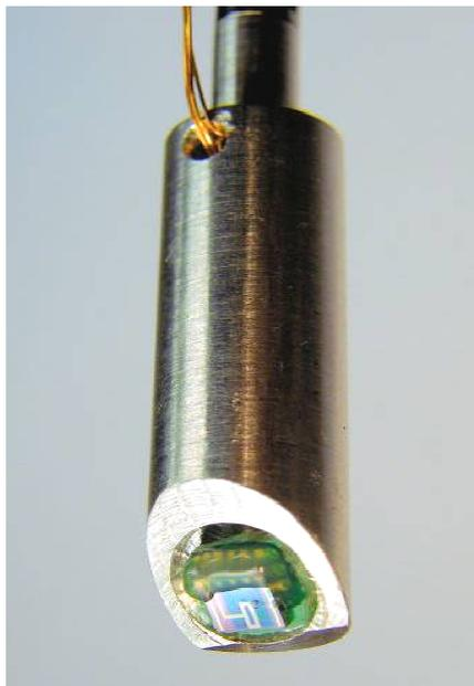
Figure II.43. Collage et connexion du capteur pH-ChemFET sur la tige de mesure
