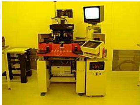
Figure II.6. Machine d'alignement et d'insolation Karl Suss MA150
