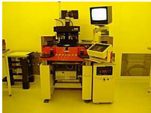
Figure II.6. Machine d'alignement et d'insolation Karl Suss MA150
