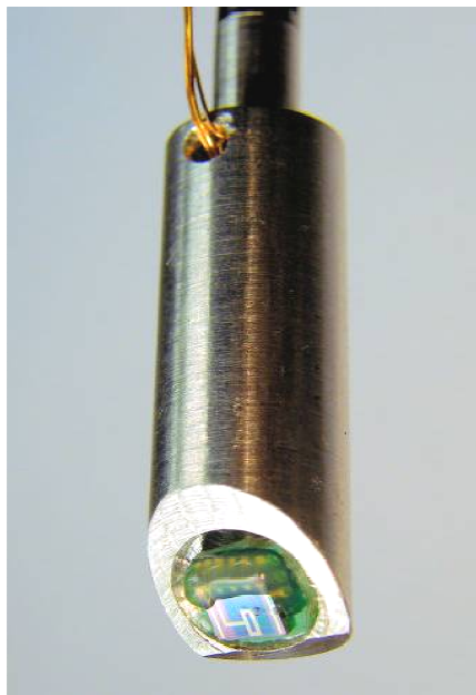
Figure II.43. Collage et connexion du capteur pH-ChemFET sur la tige de mesure
