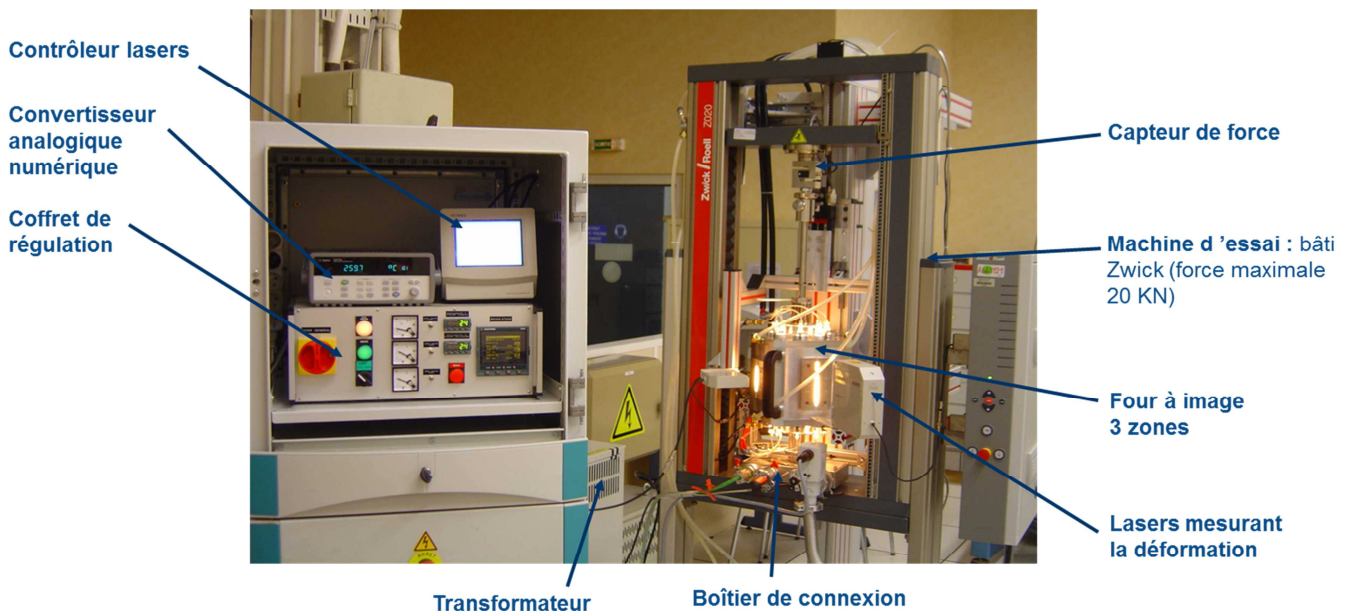
Figure I-58 : Vue d'ensemble du BAFA en fonctionnement et de ces constituants
