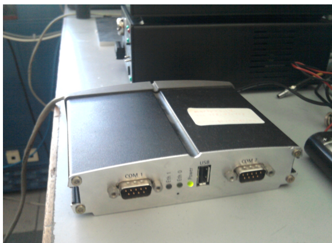
Fig. B.13 – Carte de contrôle programmable pour générer les signaux TTL.
