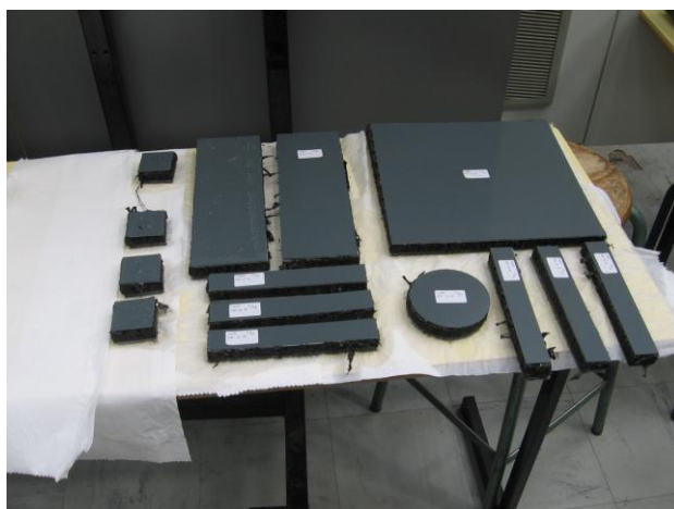
Figure 105 - Eprouvettes en fin de découpe
