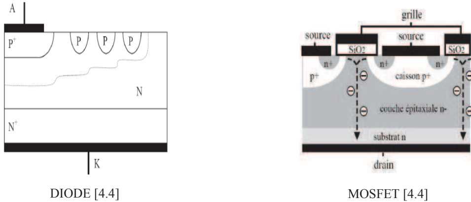
Figure 4.3. Structure des composants d'électronique de puissance
