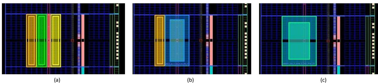
FIGURE 4.3 – Exemple de partitionnement de la région reconfigurable du FPGA en  $n$  partitions PR qui pourront accueillir des tâches matérielles de tailles différentes. (a) Sous-conception avec un partitionnement de la région en trois partitions PR, (b) sous-conception avec un partitionnement de la région en deux partitions PR, (c) sous-conception avec un région avec une seule partition PR.
