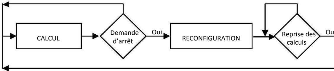
FIGURE 1.7 – Mécanisme de la reconfiguration statique d'un FPGA.
