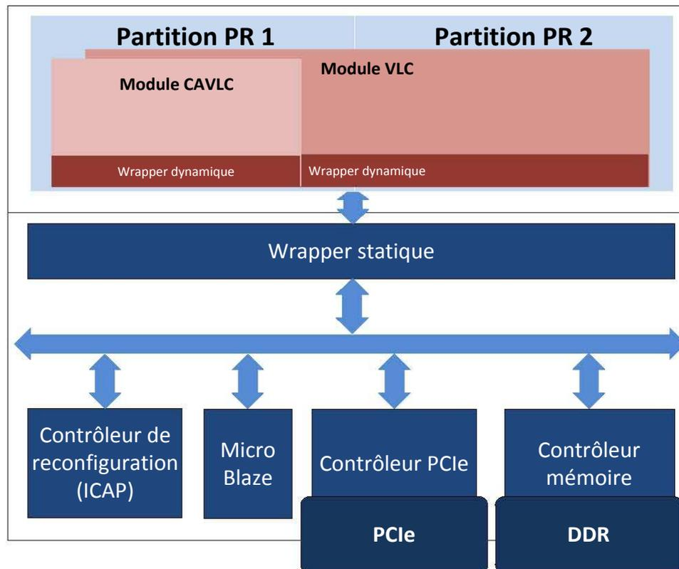
FIGURE 5.9 – Architecture avec adaptation de la région reconfigurable découpée en PR partition.
