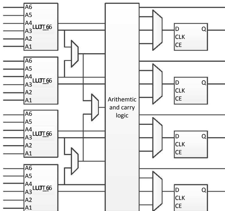
FIGURE 1.4 – Architecture d'un slice Virtex 5
