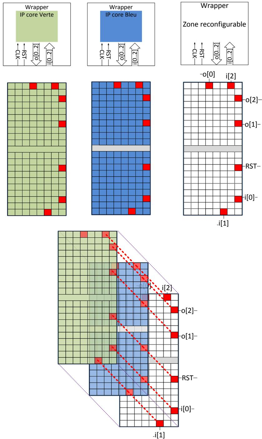
FIGURE 2.10 – Exemple d’implémentation d’IP sur une région reconfigurable.
