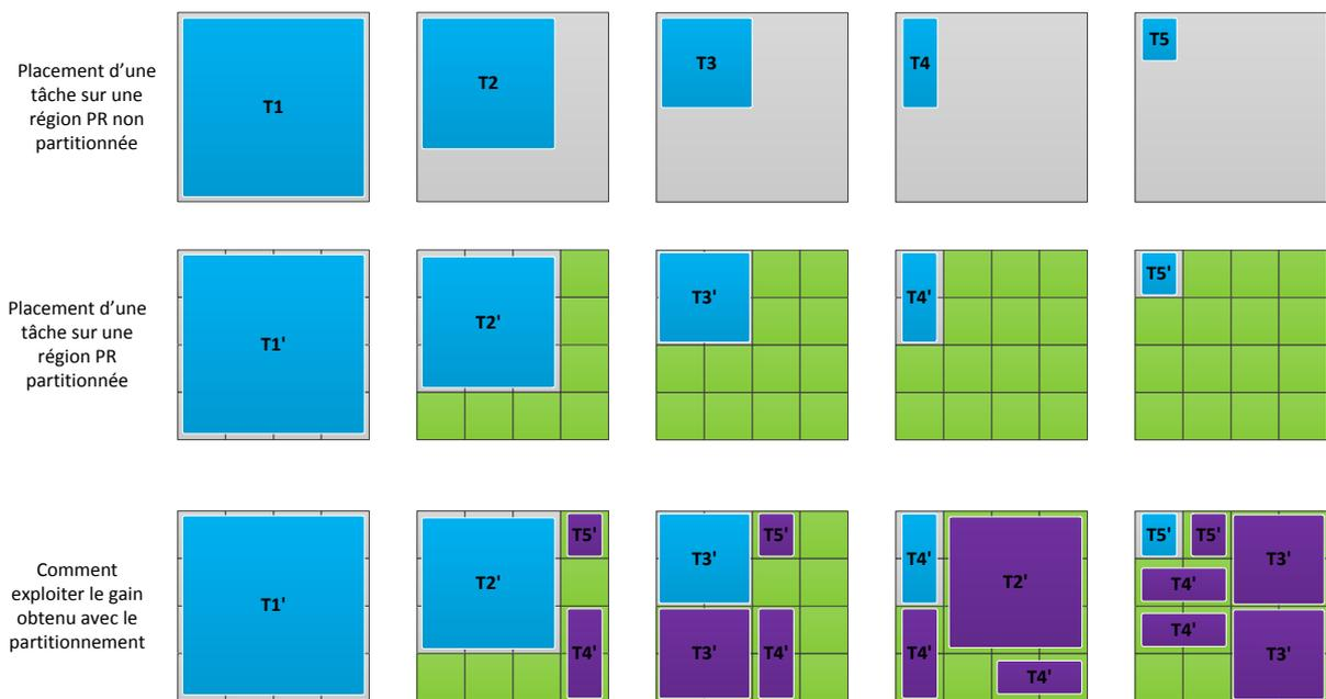
FIGURE 5.13 – Gain en surface obtenues avec le partitionnement.
