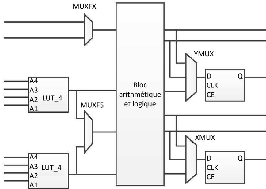
FIGURE 1.3 – Architecture d'un slice Virtex 4.
