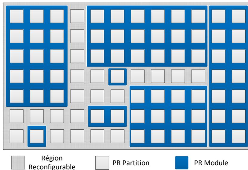
FIGURE 3.8 – Principe de l'adaptation des modules PR aux partitions PR.
