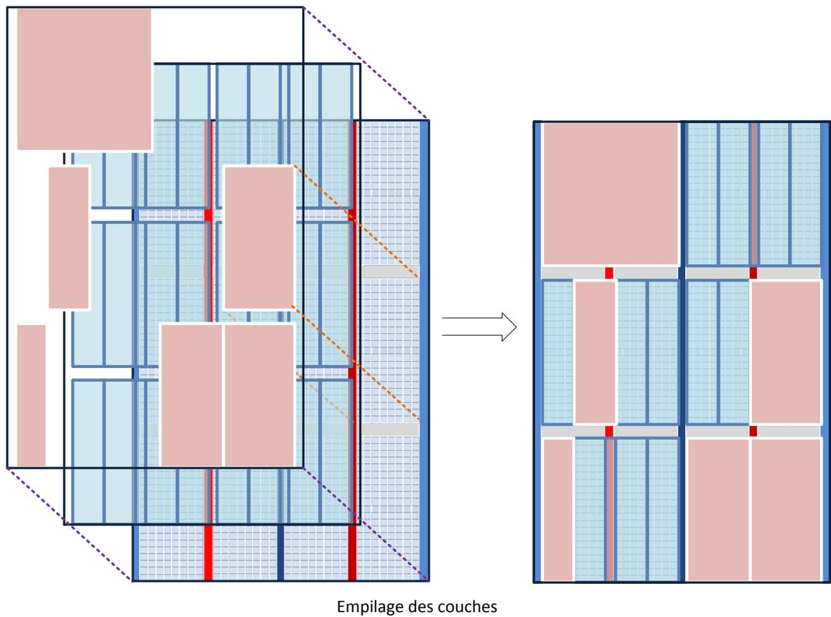
FIGURE 4.2 – Empilage des trois couches du FPGA.
