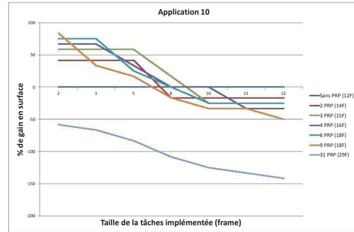
FIGURE 5.18 – Résultat sur le gain en surface pour chaque pour les applications 9 et 10 (PRP : Partition Reconfigurable Partiellement / F : frames).
