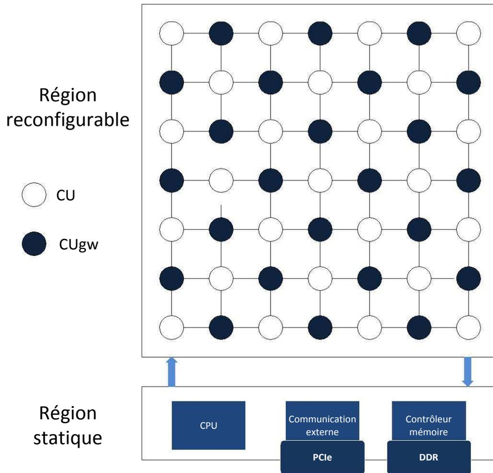
FIGURE 5.3 – Architecture reconfigurable partitionnée de type QNoC.
