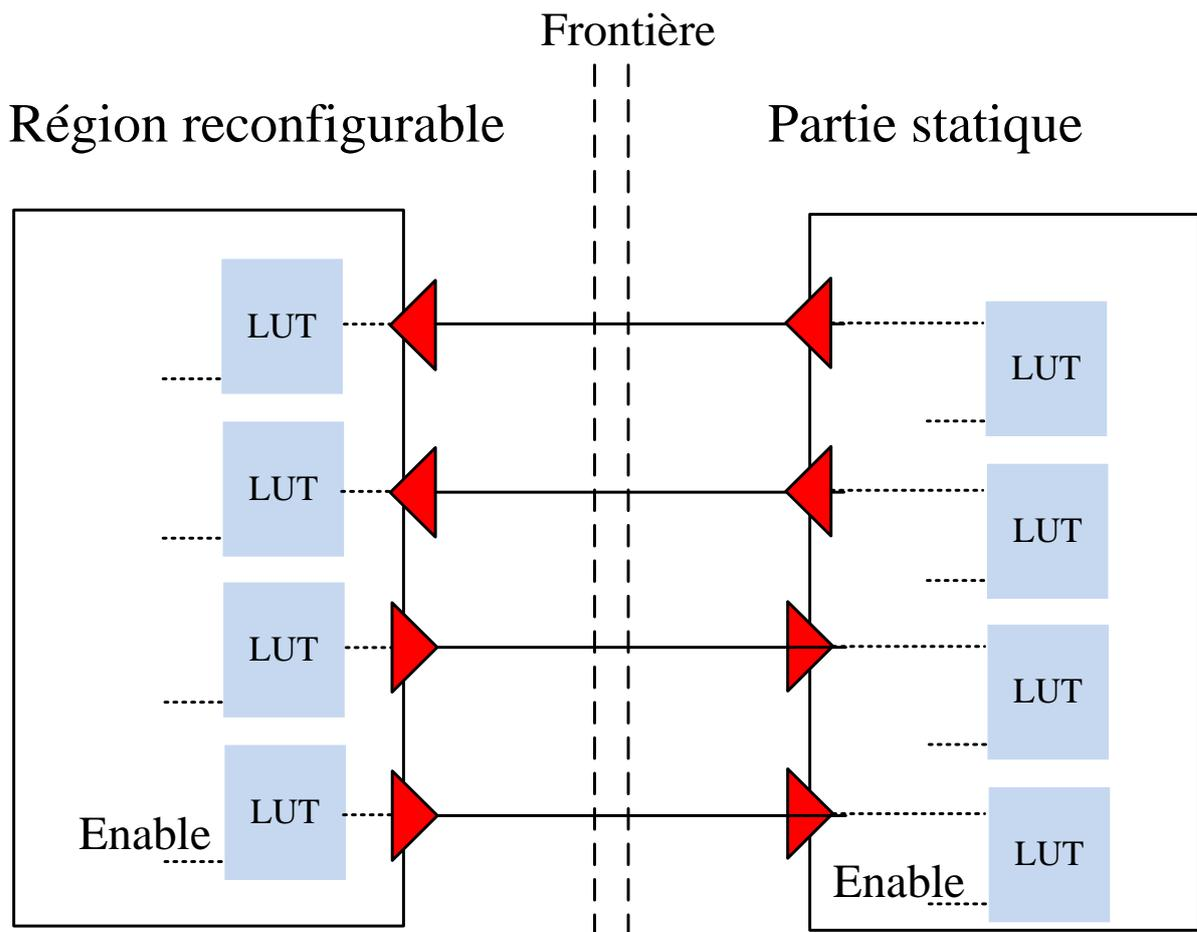
FIGURE 2.5 – Architecture d'un Slice bus macro.
