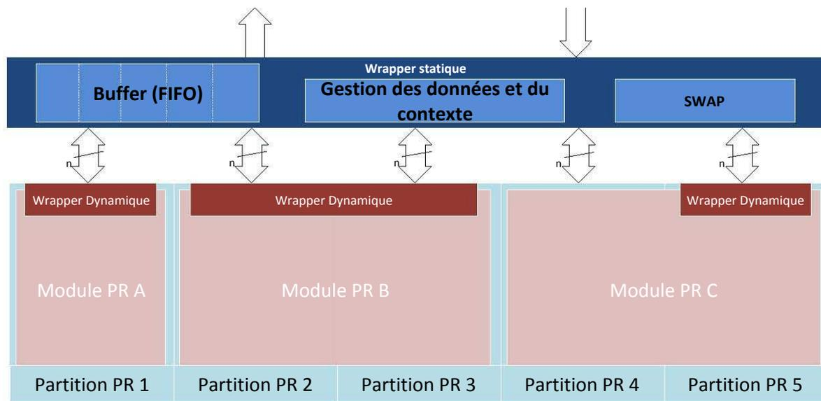
FIGURE 4.7 – Exemple avec plusieurs partitions PR.
