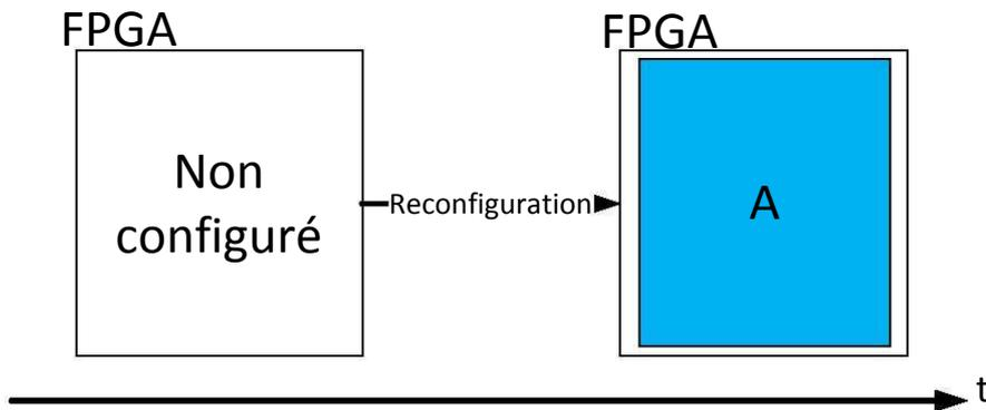
FIGURE 1.8 – Reconfiguration statique d'un FPGA.
