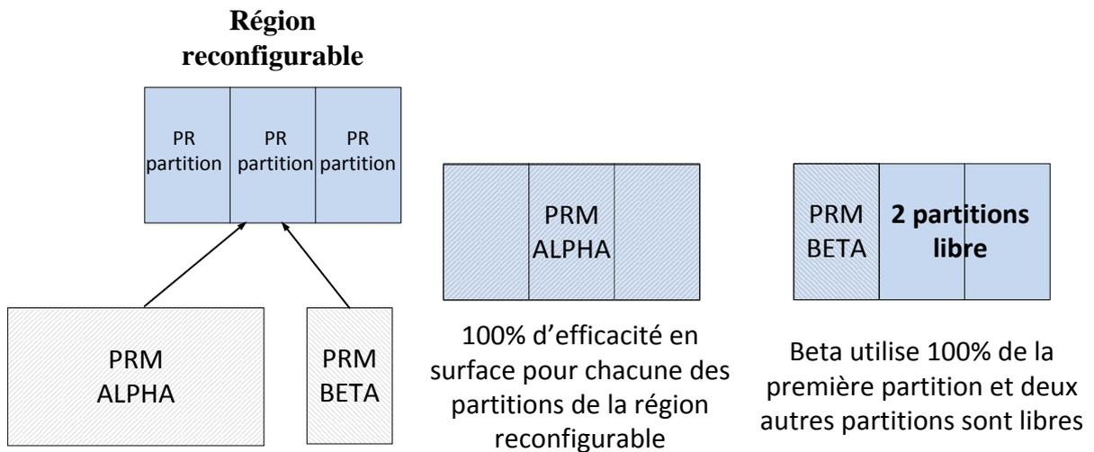
FIGURE 3.3 – Exemple de partitionnement d'une région reconfigurable.
