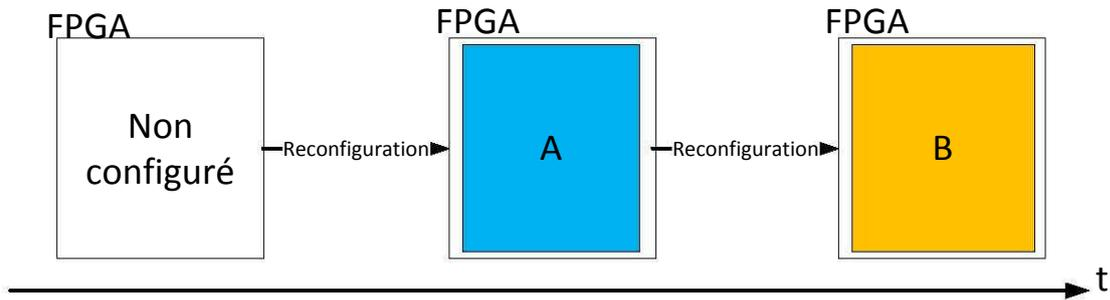
FIGURE 1.10 – Reconfiguration dynamique globale d'un FPGA.
