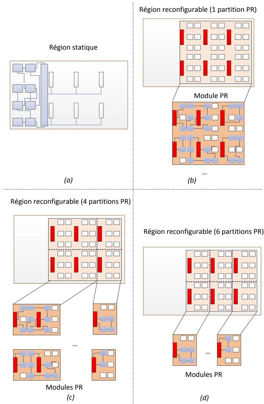
FIGURE 4.4 – Architecture permettant le placement de tâches matérielles (modules PR) de tailles différentes. (a) conception de base contenant les éléments statiques et le wrapper statique, (b) sous-conception de la région reconfigurable avec une partition PR, (c) sous-conception de la région reconfigurable avec quatre partitions PR, (d) sous-conception de la région reconfigurable avec six partitions PR.
