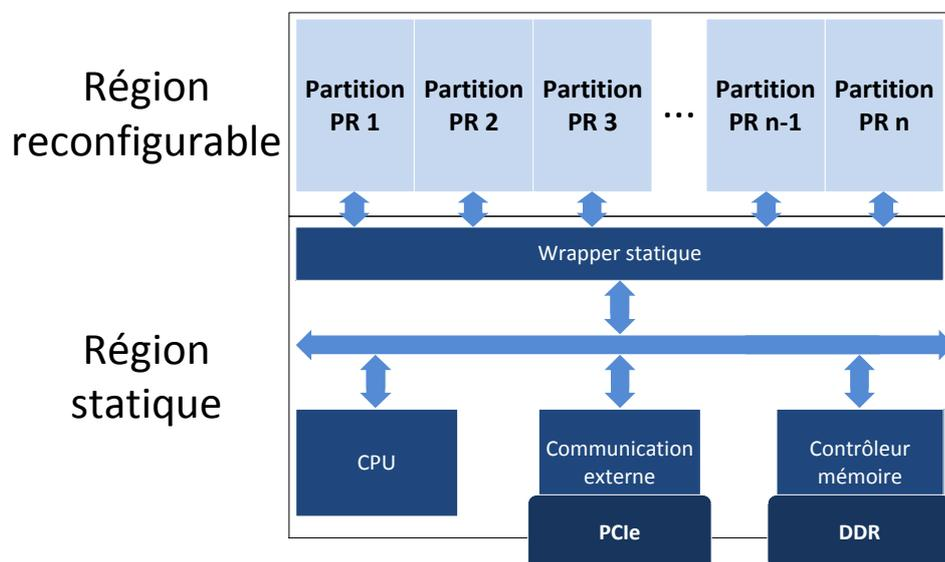
FIGURE 5.1 – Architecture reconfigurable partitionnée de type BUS.
