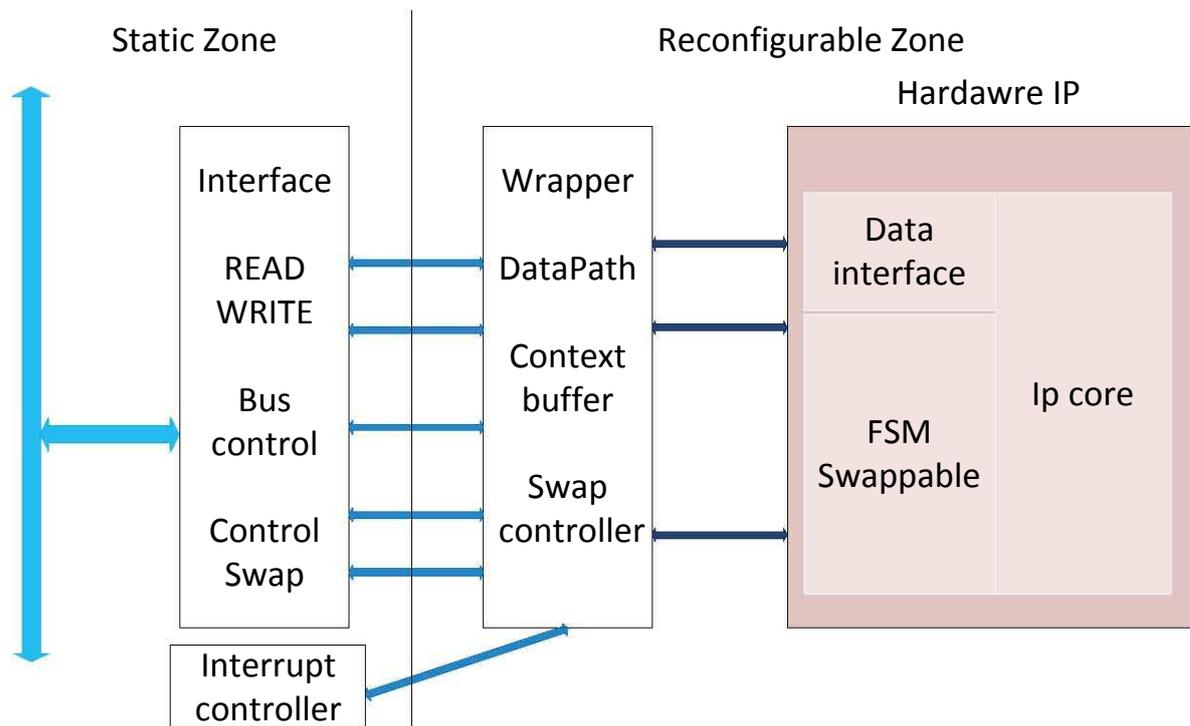
FIGURE 2.15 – Architecture avec partitionnement statique et reconfigurable [JBGR10].
