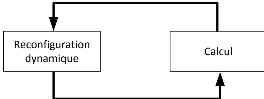
FIGURE 1.9 – Mécanisme de la reconfiguration dynamique d'un FPGA.
