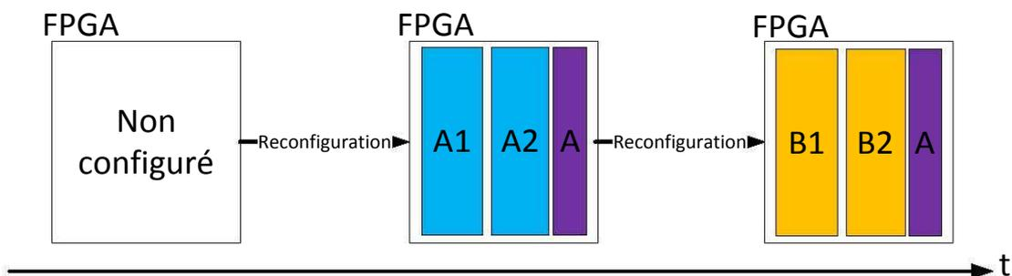
FIGURE 1.11 – Reconfiguration dynamique partielle d'un FPGA.
