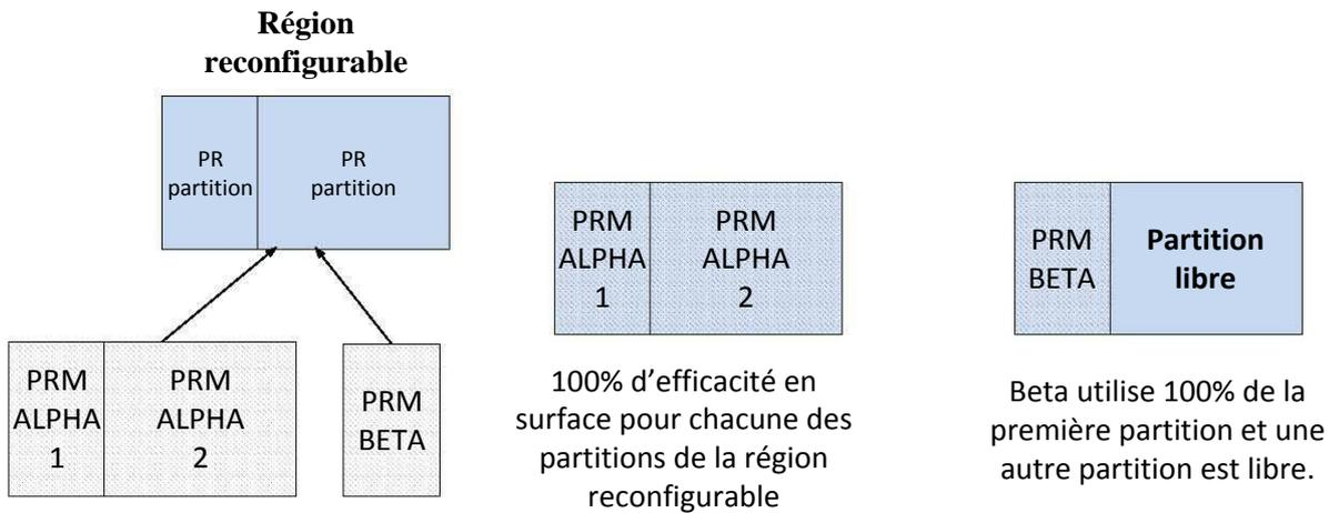
FIGURE 3.2 – Exemple de partitionnement d’une région reconfigurable.
