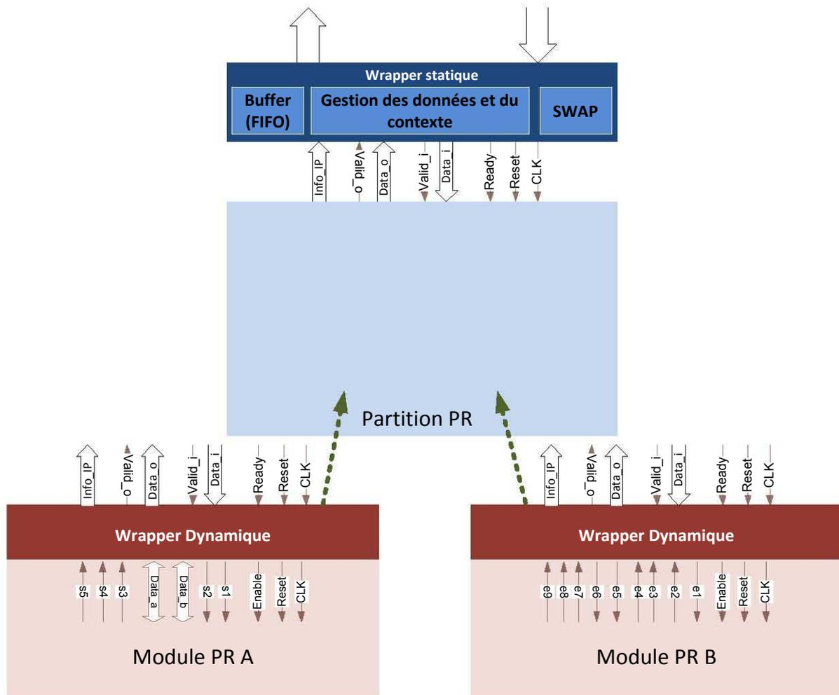
FIGURE 4.6 – Wrapper statique et dynamique d'une partition PR.
