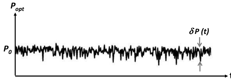
FIGURE 1.12 – Evolution temporelle de la puissance en sortie d'un laser.
