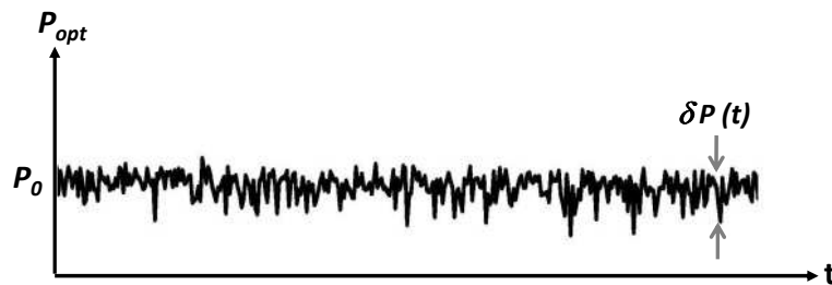
FIGURE 1.12 – Evolution temporelle de la puissance en sortie d'un laser. Fluctuations de la puissance de sortie d'un laser \delta P(t) autour de sa valeur moyenne P_0 .
