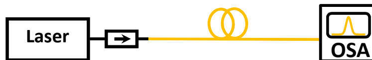
FIGURE 2.15 – Schéma de principe pour générer de la SPM et de l'effet Raman dans une fibre.
