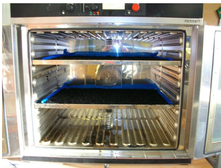
Figure 2.2: Dispositif d'étuvage du PA66GF50
