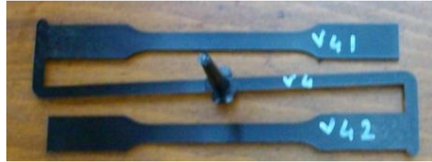
Figure 2.5 : Moulée obtenue sur presse Billion® suivant la norme ISO525-2-1A
