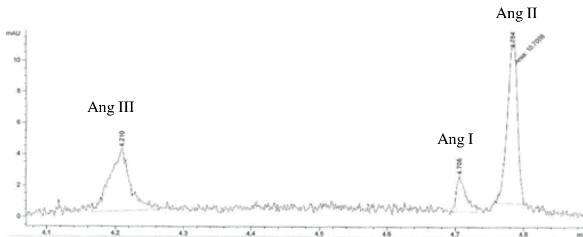
Figure A3-2 Electrophérogramme d'un mélange de peptide (Angiotensine I, Angiotensine II et Angiotensine III) à une concentration de 30 \mu\text{M} dans un tampon borate 80 \text{ mM} , \text{pH } 8,4 . Capillaire de 50 \mu\text{m} de diamètre interne, 75 \text{ cm} de long, 66,5 \text{ cm} à la détection. Injection 50 \text{ mbar} pendant 5 \text{ secondes} . Tension 30 \text{ kV} .
