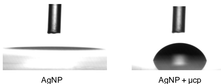
Figure 3-8 Illustration des angles de contact d'une goutte d'eau posée à la surface d'un substrat de verre nettoyé (substrat de base ; II.1.1.1) recouvert d'une couche mince de nanoparticules à base d'argent et d'étain avant (AgNP) et après microtamponnage (temps de contact 20 s) d'une solution d'octadécane-thiol (2 mM - éthanol) (AgNP + \mu cp) à l'aide d'un tampon plan sans microstructures.
