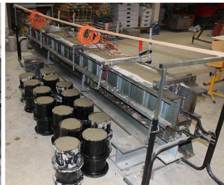
(c) Coulage d'une poutre avec des éprouvettes 16x32 cm pour la caractérisation du béton en compression
