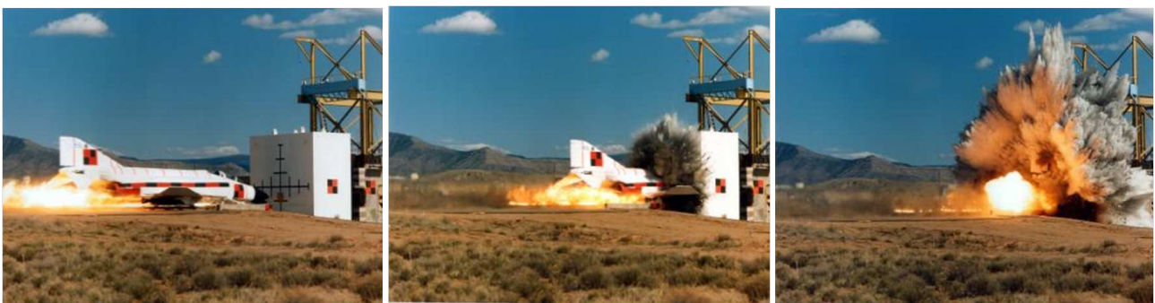
FIG. 1 – Essai d'impact d'un avion sur un mur en béton armé (vitesse d'impact 215 m/s), d'après [Sugano et al. , 1993]. Sandia National Laboratories, Etats-Unis, 1988.
