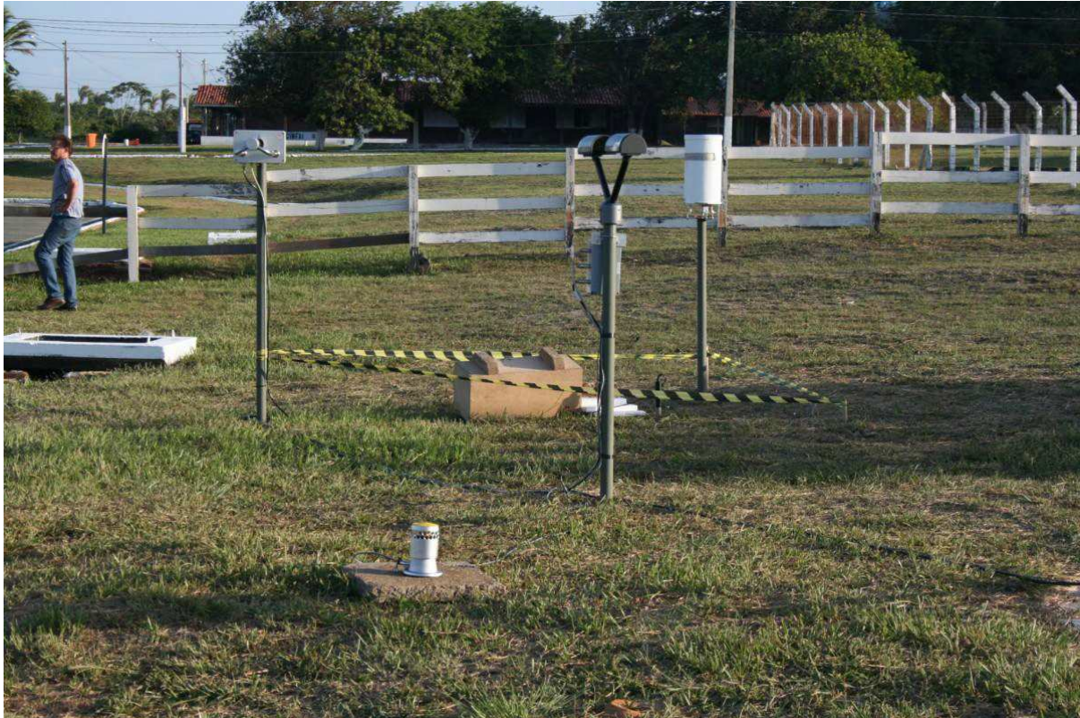
Photographie de la mise en place d'instruments de mesure des précipitations lors de la campagne CHUVA à Alcantara (MA, Brésil) (source : CHUVA).
