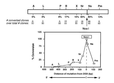
Figure 41 : Fréquence d'insertion de mutations silencieuses selon de la distance à la cassure (Elliott, et al., 1998)
