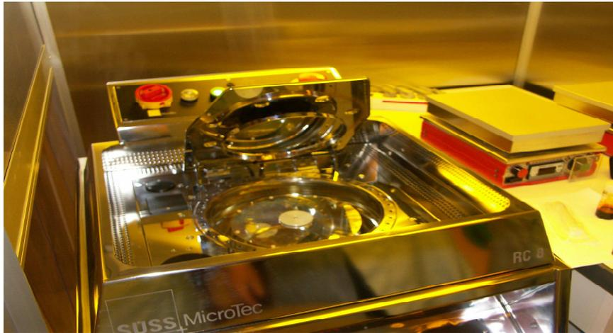
Figure II 18 : Photographie de la tournette Suss Microtec RC8 utilisée en salle blanche de l'ENS Cachan.
