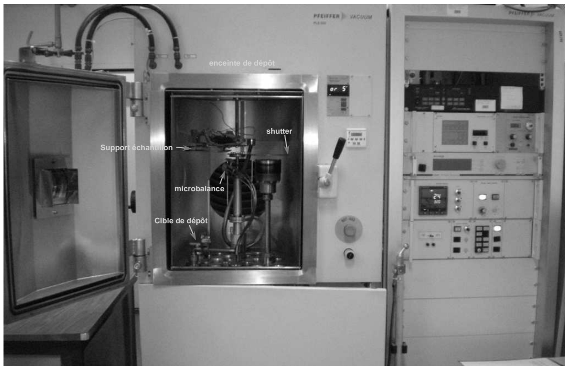
Figure 5 : Vue générale du montage d'évaporation sous vide
