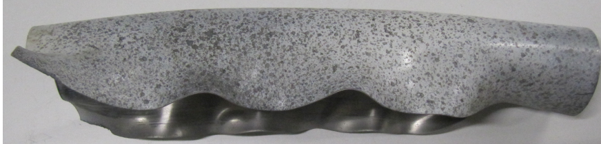
Fig. 2.47. Observation côté latéral du tube déformé ( L_f = 20\text{mm} )
