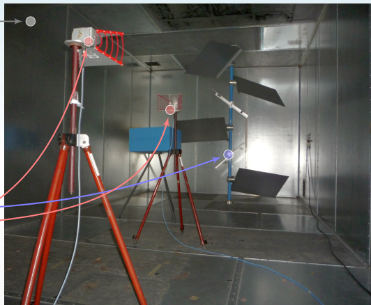
La chambre réverbérante de l'IETR (L 8.7 m, l 3.7 m, H 2.9 m).
