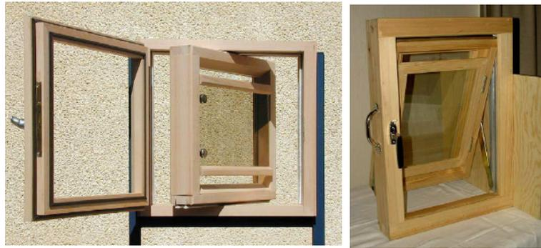
FIGURE 2.28 – Deux prototypes de la fenêtre réversible de [Erell *et al.*, 2004]
