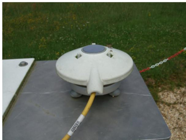
FIGURE 2.12 – Pyrgéomètre du site EDF R&D des Renardières
