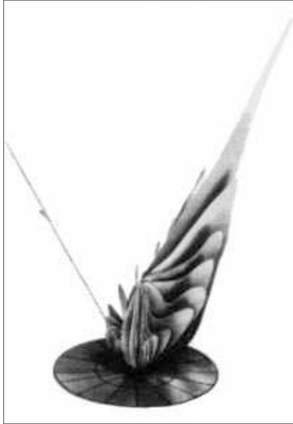
Figure 17: Sculpture représentant la distribution de la luminance réfléchie par unité de luminance incidente produite par un faisceau de lumière collimatée (à gauche) incident à 33,2^\circ sur un morceau d'aluminium. Cette sculpture est faite de pans verticaux dont la découpe suit la variation de la distribution. L'échelle logarithmique «azimutale» utilisée pour reporter les valeurs de f_r , accentue les variations pour les valeurs peu élevées
