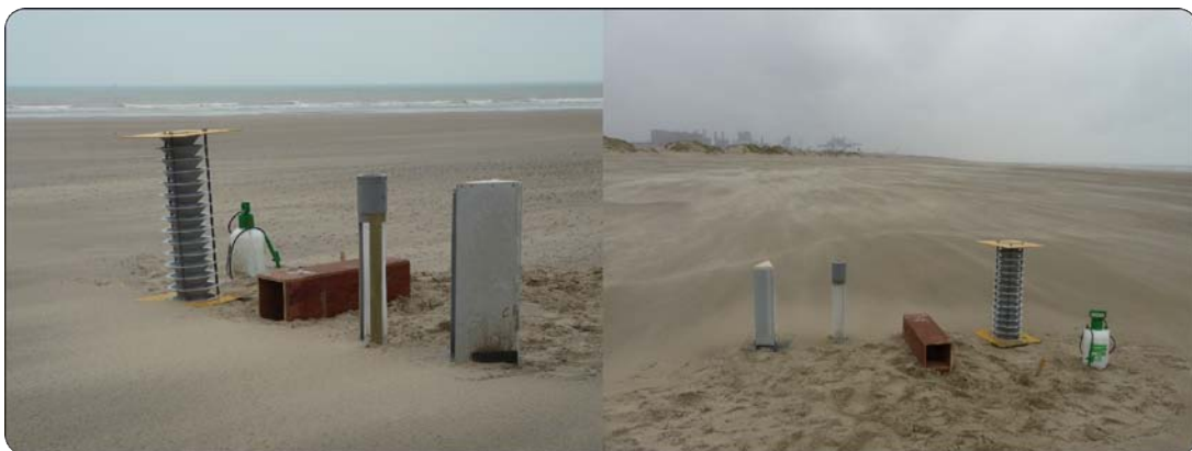
Figure 2.18. Photographies de l'expérimentation de terrain visant à comparer différents types de pièges à sable (Photographie A. Tresca, 14.01.11)
