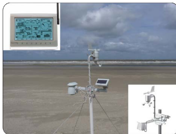
Figure 2.20. Station météorologique Professional Oregon Scientific WMR 200 : data logger, capteurs, et photographie sur le terrain (Photographie A.Tresca)
