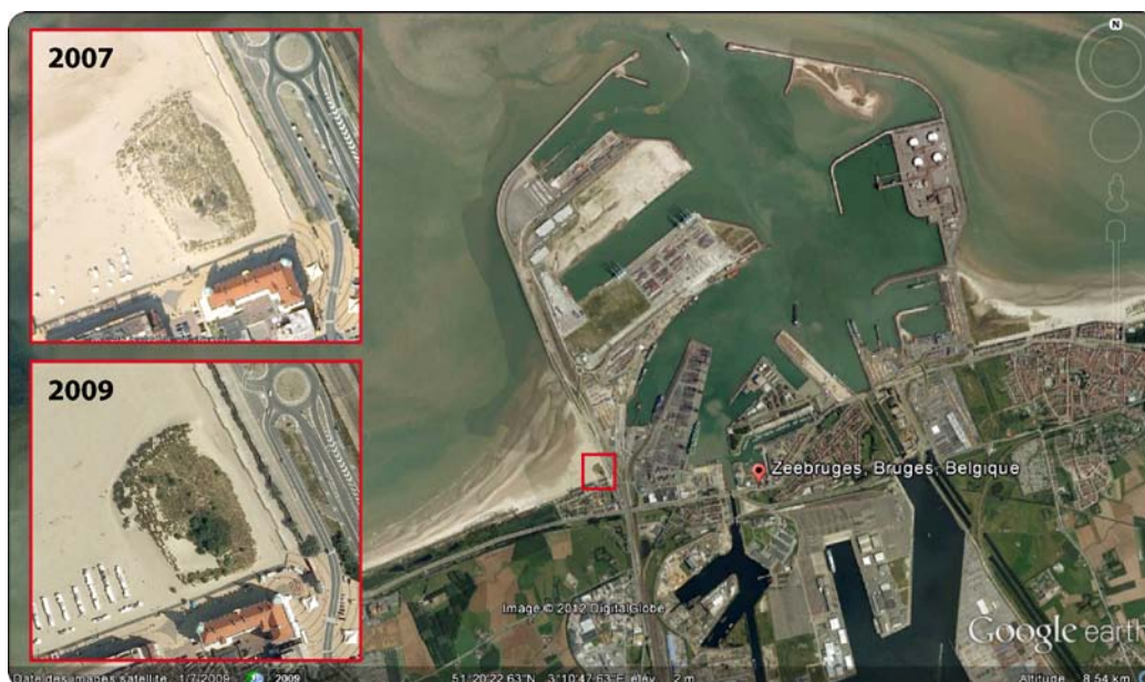
Figure 7.2. Vue aérienne de l'avant-port de Zeebrugge (Belgique) avec, en médaillons, des zooms en 2007 et en 2009 sur les dunes formées près de la jetée Ouest © Google Earth
