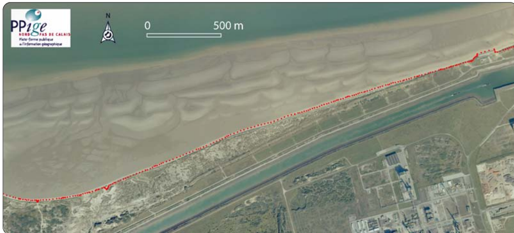
Figure 2.10. Exemple du semis de points (en rouge) obtenu lors d'un lever du trait de côte à l'aide du récepteur GNSS le 07/09/2010 (superposé à une vue aérienne de 2005), et tableau des dates de lever du trait de côte.
