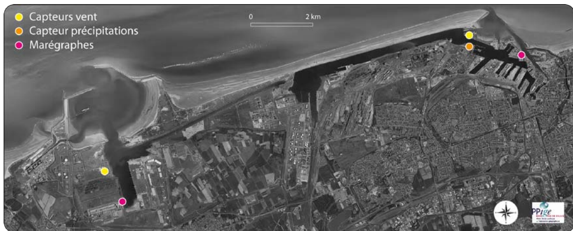
Figure 2.21. Carte de localisation des capteurs de vent, précipitations (MétéoFrance) et des marégraphes.
